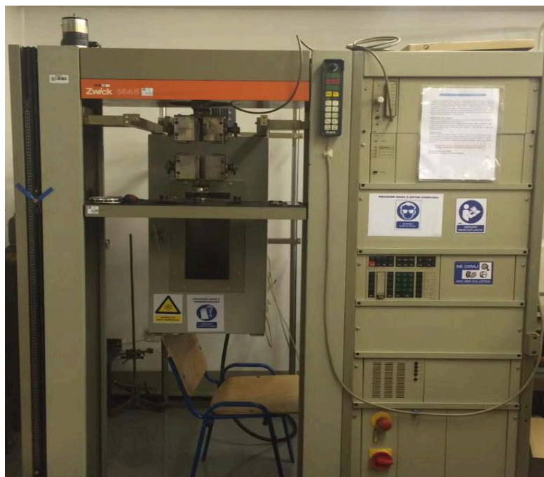
Slika 16. Mehanička kidalica, Zwick 1445.
