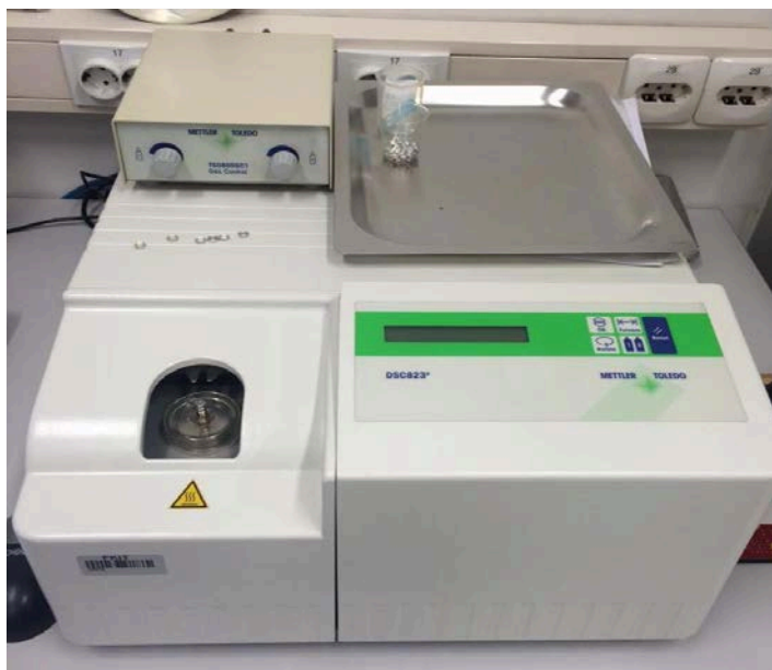
Slika 17. Razlikovni pretražni kalorimeter, Mettler Toledo DSC 823e.
