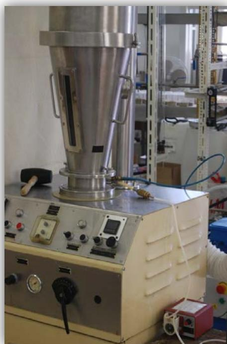
**Slika 3.1.** Fotografija granulatora s fluidiziranim slojem
