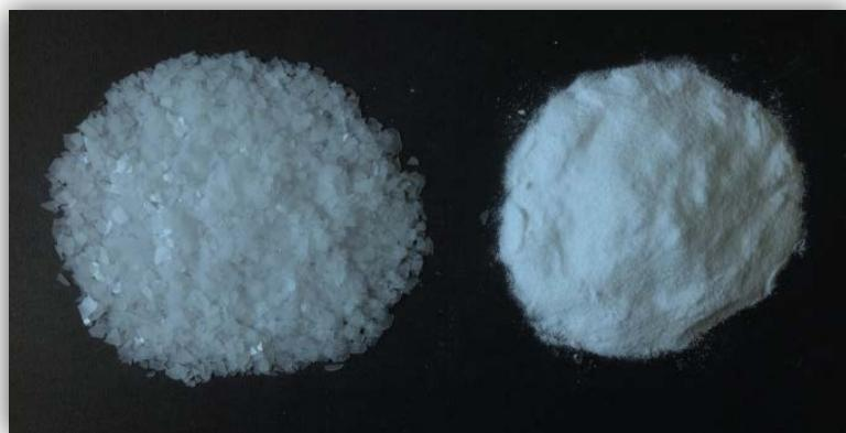
**Slika 3.7.** Usporedni prikaz inicijalnog (lijevo) i usitnjjenog (desno) polietilen glikola.
