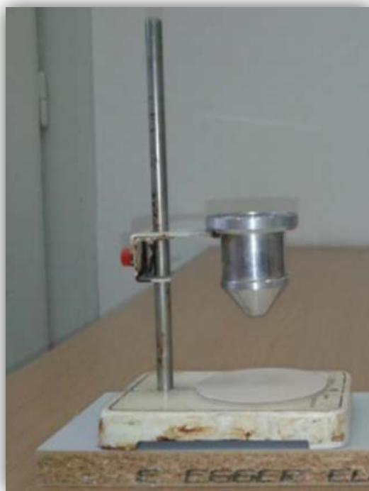
**Slika 3.4.** Fotografija lijevka za određivanje kuta mirovanja
