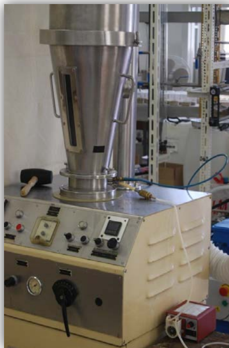
Slika 3.1. Fotografija granulatora s fluidiziranim slojem Uni-Glatt (Glatt GmbH, Binzen, Njemačka).
