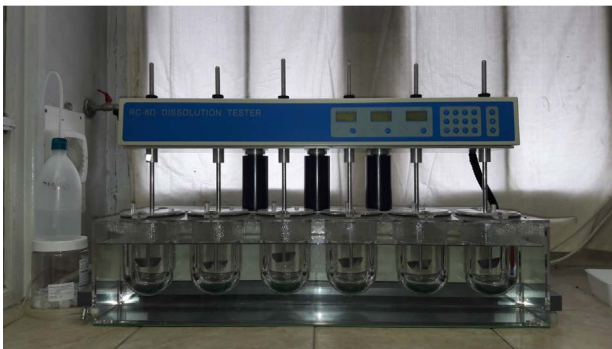
Slika 3.6. Fotografija uređaja za određivanje profila otpuštanja djelatne tvari RC-6D (Zhengzhou Nanbei Instruments, Zhengzhou, NR Kina).
