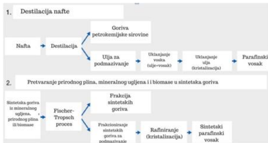
Slika 12. Shema dobivanja parafinskog voska [8]
