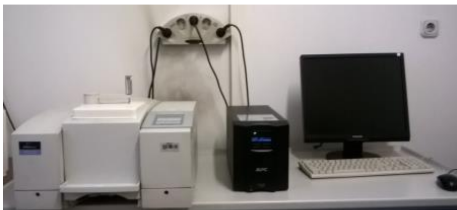
Slika 14. Perkin Elmer Spectrum One Spectrometer FTIR-ATR povezan s računalom
