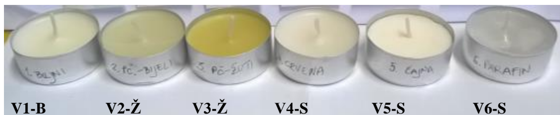
Slika 18. Uzorci „svijeća“ različitih voskova za ispitivanje brzine gorenja
