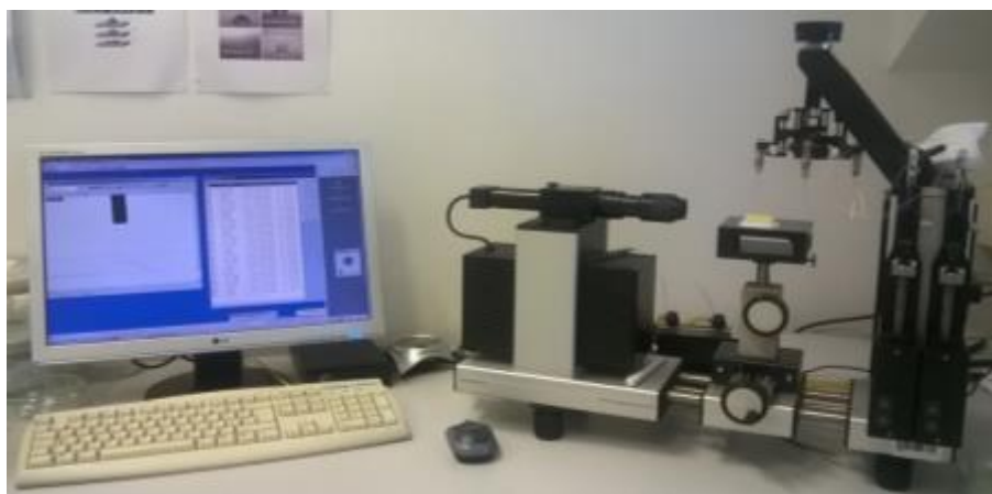
Slika 15. Goniometar DataPhysics OCA Instruments GmbH povezan s računalom
