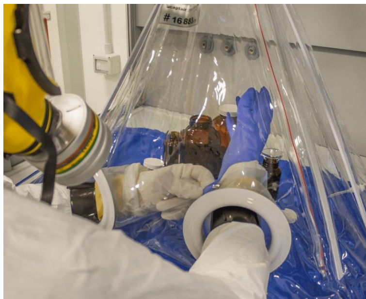
Slika 9. Procesna komora za rad s nanočesticama
