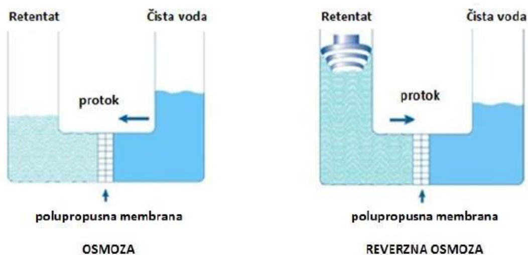
Slika 2.3. Shematski prikaz procesa osmoze i reverzne osmoze.
