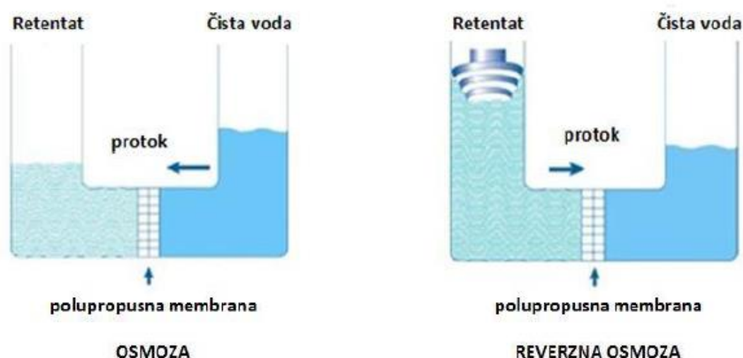
Slika 2.3. Shematski prikaz procesa osmoze i reverzne osmoze.
