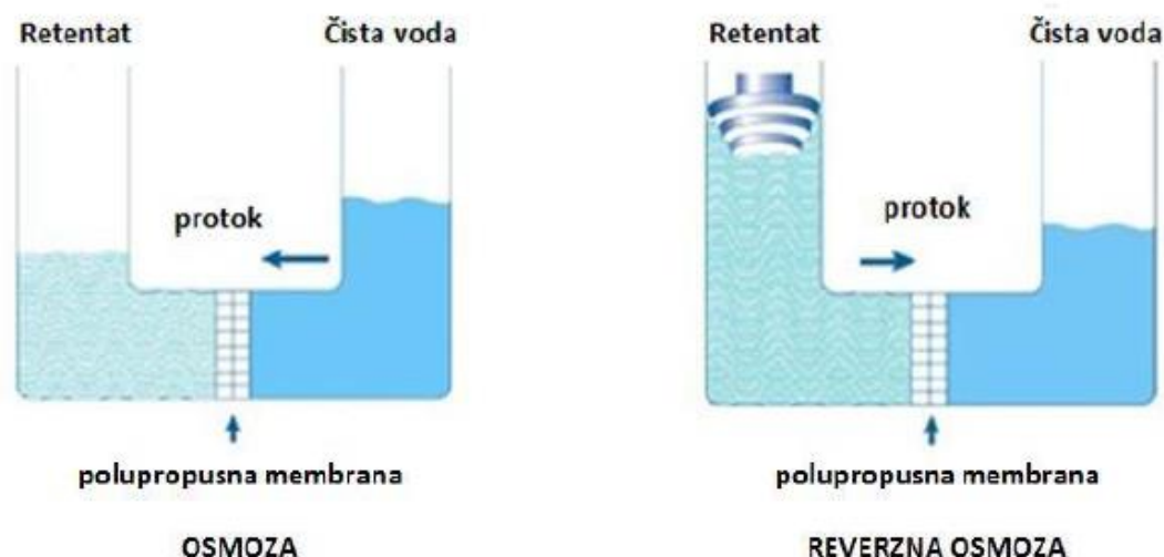
Slika 2.3. Shematski prikaz procesa osmoze i reverzne osmoze.
