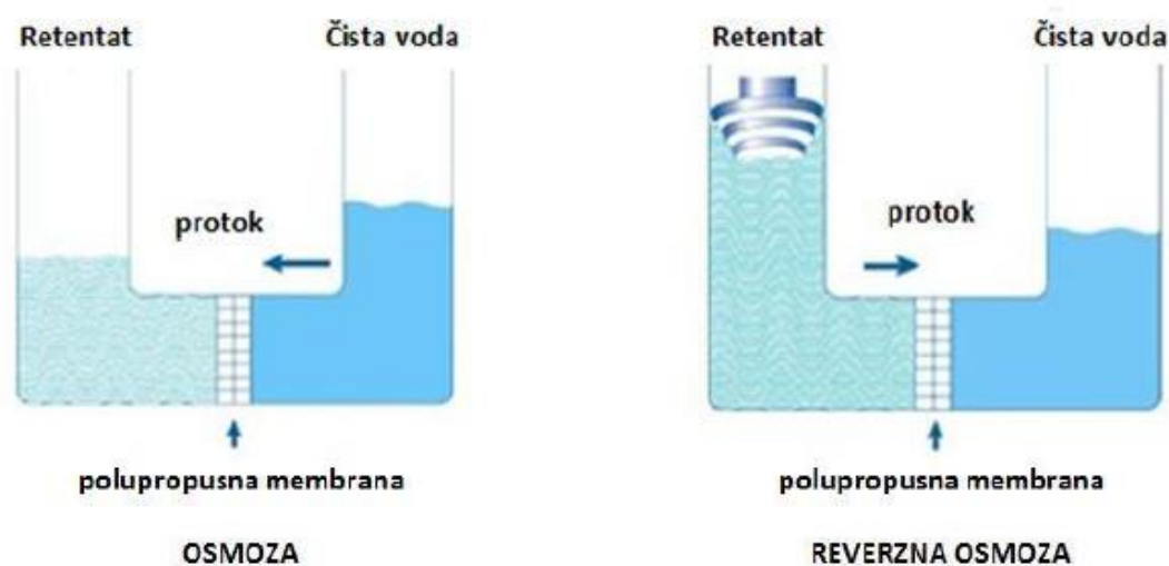
Slika 2.3. Shematski prikaz procesa osmoze i reverzne osmoze.
