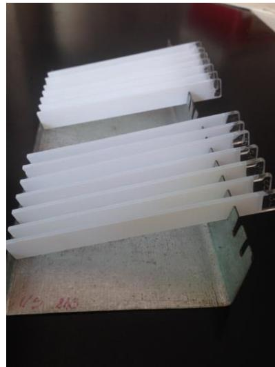
Slika 10. Staklene pločice sa TiO<sub>2</sub> filmom
