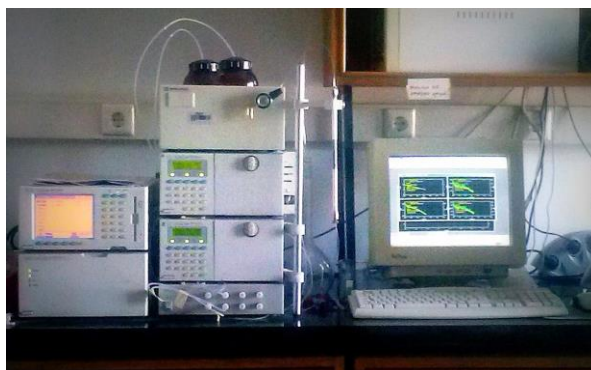
Slika 7. HPLC uređaj, Shimadzu serije 10
