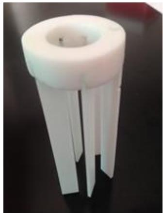
Slika 12. Teflonski nosač sa šest pločica
