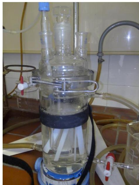
Slika 13. Reaktor za ozonaciju sa uronjenim pločicama
