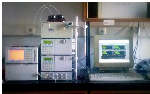
Slika 7. HPLC uređaj, Shimadzu serije 10
