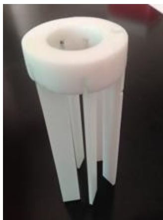
Slika 12. Teflonski nosač sa šest pločica
