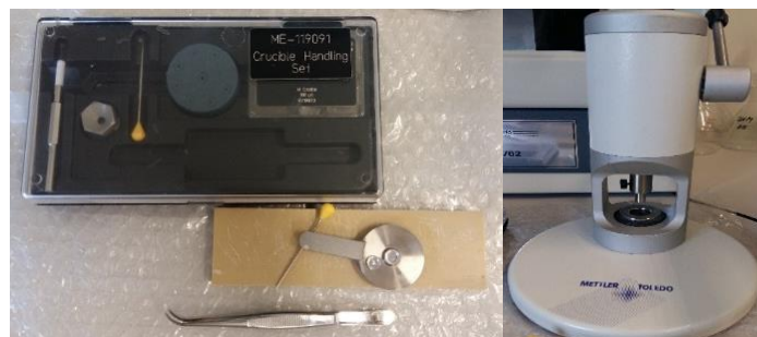
Slika 34. Nosač Al posudice i preša za pripremu uzoraka za DSC mjerenja
