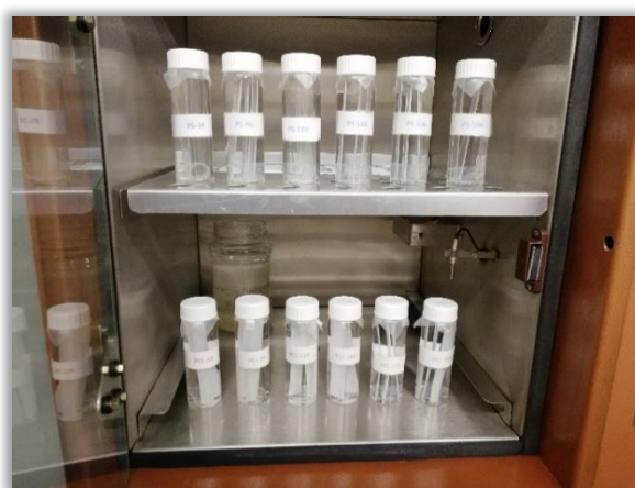
Slika 20. Inkubator i bočice s pločicama PS i PCL polimera stavljenje u inkubator, na 37°C u vremenu od 4 tjedna
