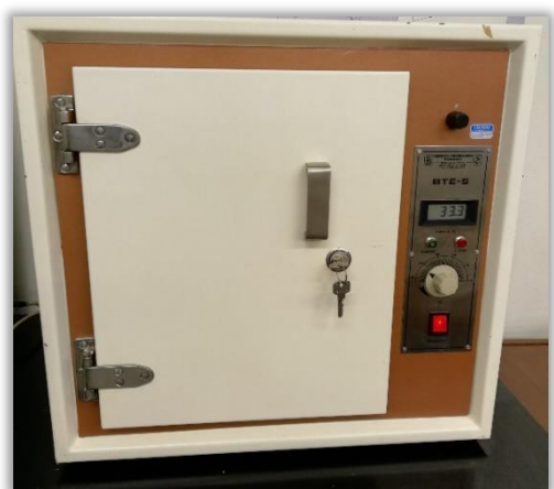
Slika 20. Inkubator i bočice s pločicama PS i PCL polimera stavljenje u inkubator, na 37°C u vremenu od 4 tjedna
