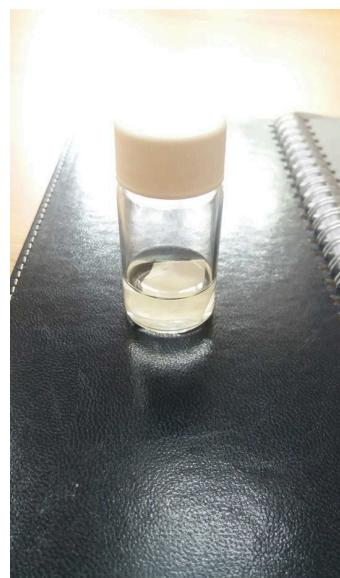
Slika 15. Elektroispredeni PCL/CFU vlaknasti nosač u fiziološkoj otopini
