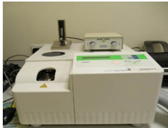
*Slika 12. DSC analizator Mettler Toledo 822e*
