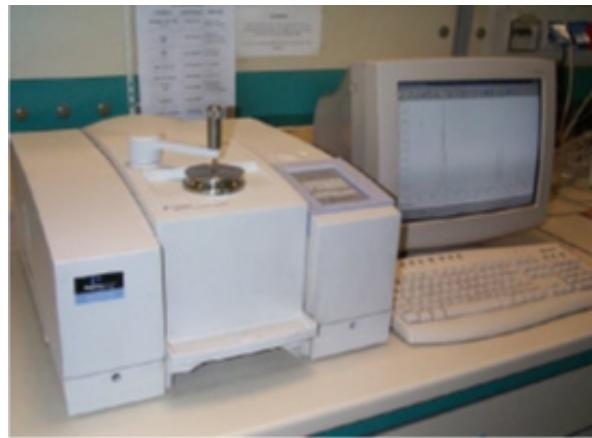
*Slika 13. Perkin Elmer, Spectrum One FTIR spektrometar*
