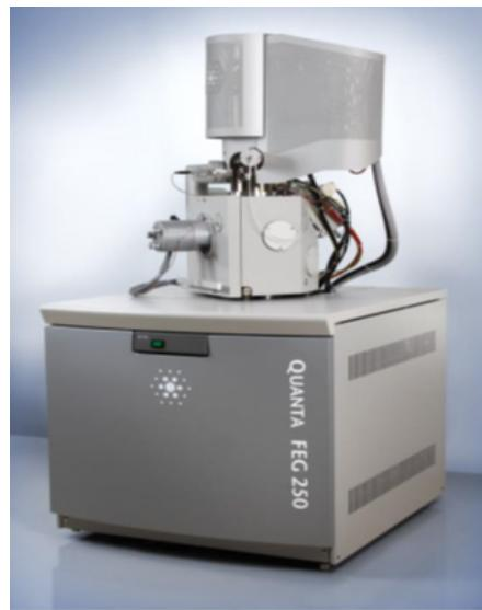
Slika 14. SEM mikroskop QUANTA 250, FEI
