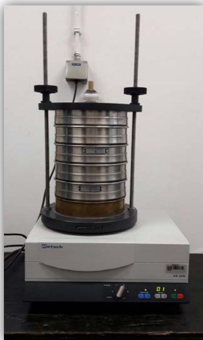
Slika 3.3. Fotografija uređaja za potresivanje sita AS 200 (Retsch GmbH, Haan, SR Njemačka).
