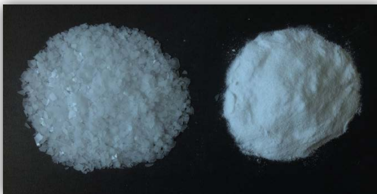
Slika 3.7. Usporedni prikaz inicijalnog (lijevo) i usitnjenog (desno) polietilen glikola.
