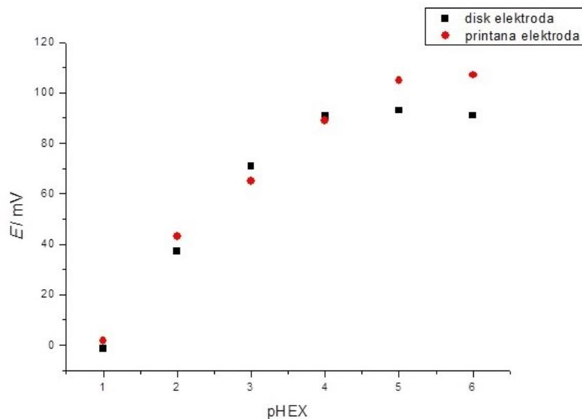
**Slika 31.** Mjerenja odziva potenciostatski modificirane  $\text{Ag}|\text{Ag}_4[\text{Fe}(\text{CN})_6]$  disk elektrode i printane elektrode na koncentraciju heksacianoferata(II).
