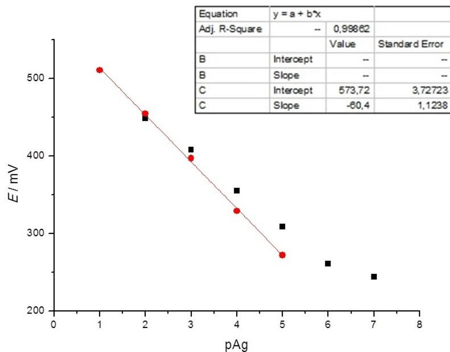
**Slika 20.** Statistička obrada rezultata mjerjenja prikazanih na gornjoj slici.
