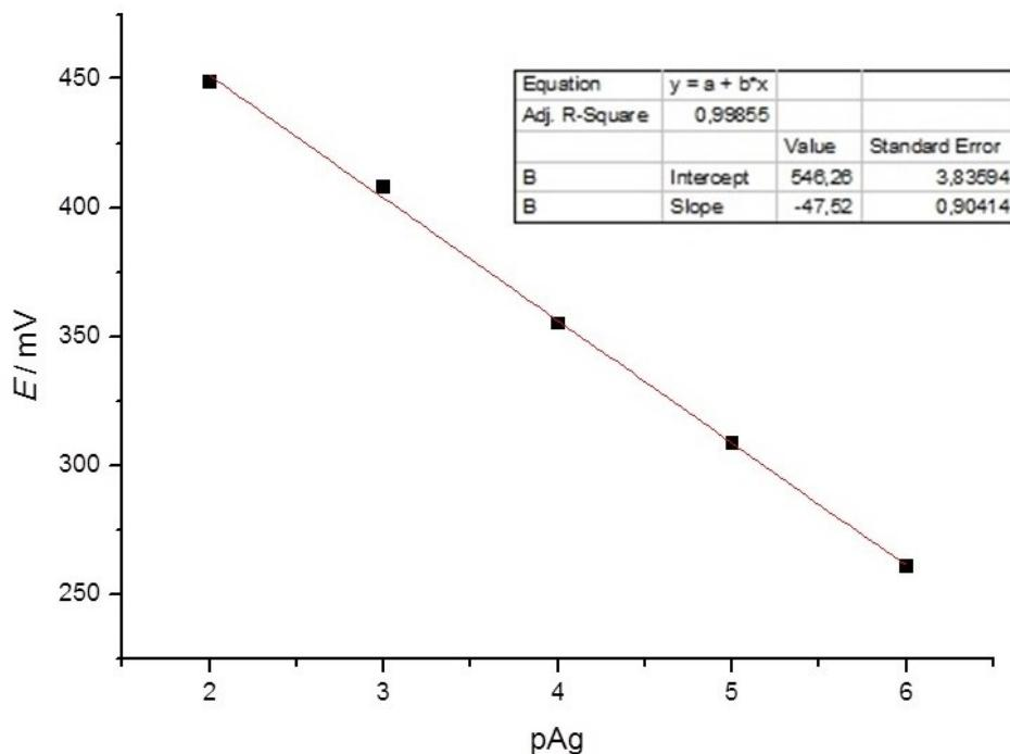
**Slika 18.** Statistička obrada rezultata dobivenih mjerenjem Ag-elektrodom kemijski modificiranom kondicioniranjem 72 sata u otopini 1 mM  $\text{Ag}_4[\text{Fe}(\text{CN})_6]$  u 0,1 M  $\text{NaNO}_3$  koja je prethodno podvrgnuta struji argona.
