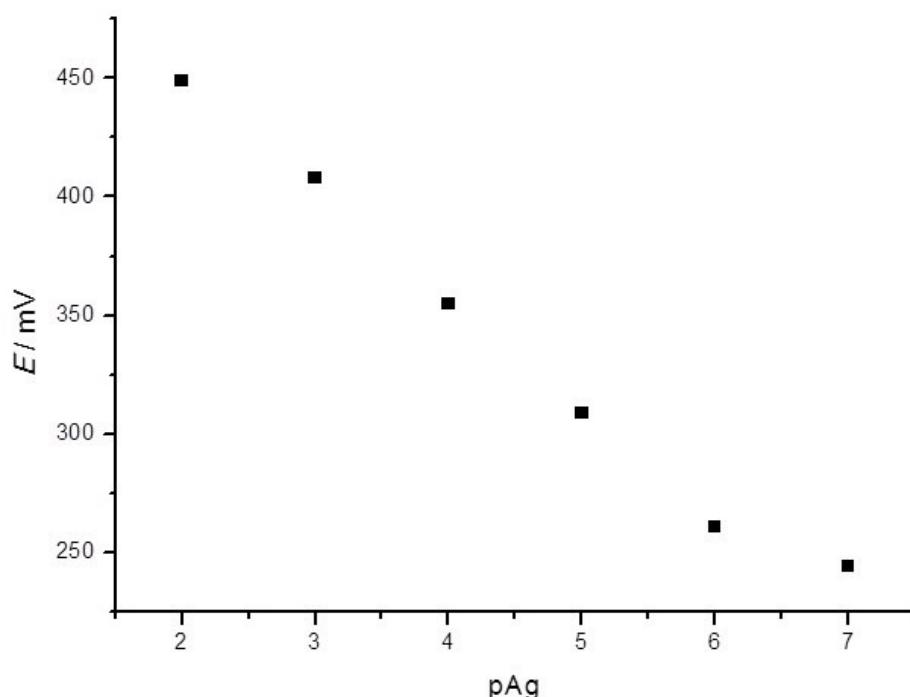
**Slika 17.** Odziv Ag-elektrode kemijski modificirane kondicioniranjem 72 sata u otopini 1 mM  $\text{Ag}_4[\text{Fe}(\text{CN})_6]$  u 0,1 M  $\text{NaNO}_3$  koja je prethodno podvrgnuta struji argona.
