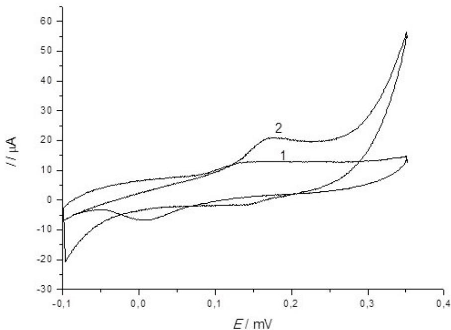
**Slika 24.** Usporedba cikličkih voltamograma disk elektrode prije i nakon formiranja  $\text{Ag}_4[\text{Fe}(\text{CN})_6]$  sloja. Snimljeno u 0,1 M otopini natrijeva nitrata. Val 1 odgovara odzivu  $\text{Ag}$ -disk elektrode u otopini natrijeva nitrata dok val 2 odgovara odzivu modificirane  $\text{Ag}$  disk-elektrode.
