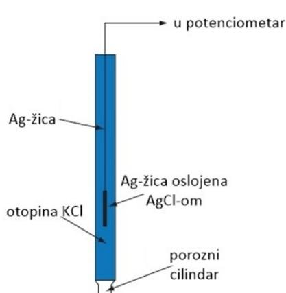
**Slika 3.**  $Ag|AgCl$  referentna elektroda.
