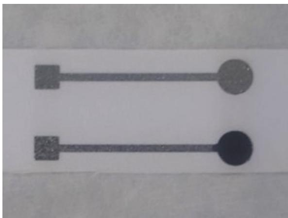
**Slika 16.** Usporedba elektroda: prije i nakon što je naneseno 3 µL nanosrebra.
