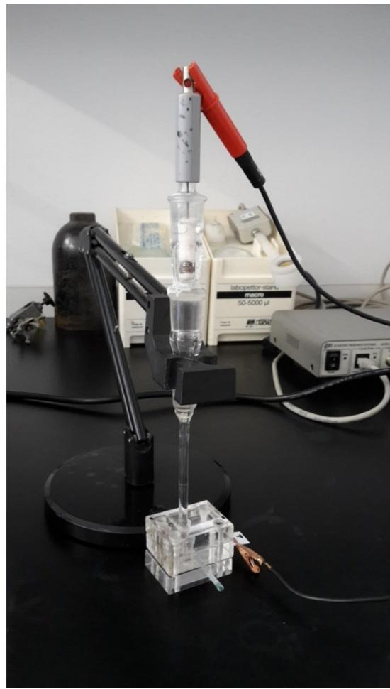
**Slika 14.** Nepprotočna celija za potenciometrijsko mjerjenje.
