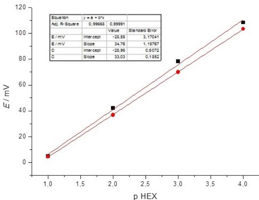
**Slika 27.** Statistička obrada rezultata baždarenja Ag-elektrode (printane i disk) pomoću SO  $K_4[Fe(CN)_6]$
