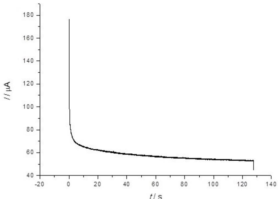
Slika 29. Potencijostatska priprema *printane* Ag–elektrode pri uvjetima navedenim na Slici 28
