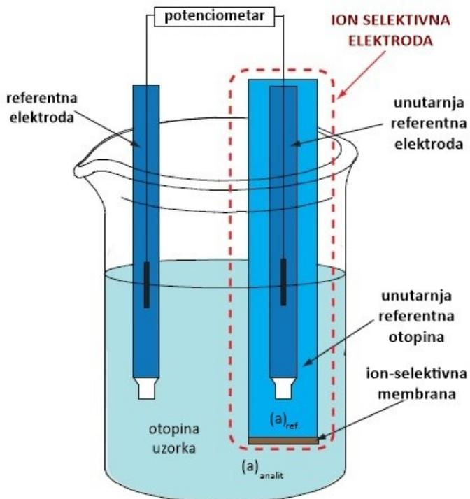
**Slika 5.** Shematski prikaz potenciometrijske čelije sa ISE.
