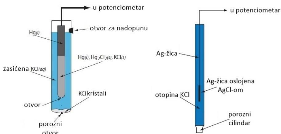
**Slika 2.** Zasićena kalomel elektroda.
