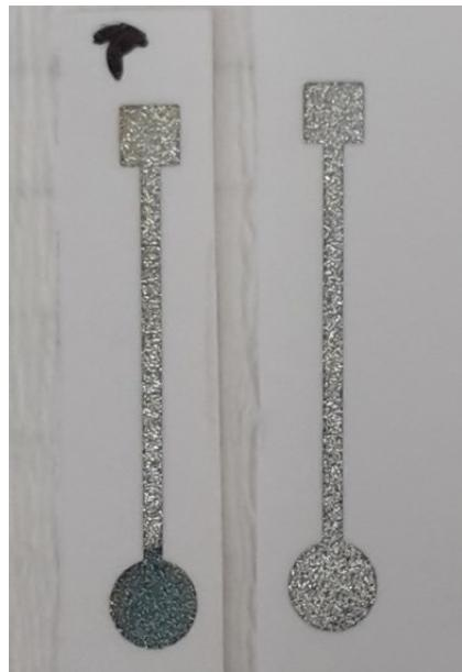
**Slika 30.** Usporedba elektroda: elektrode su *printane* na plastičnoj podlozi *ink-jet* tehnikom; elektroda P oslojena je elektrokemijskim potencijostatskim postupkom te je vidljiv sloj  $\text{Ag}_4[\text{Fe}(\text{CN})_6]$ .
