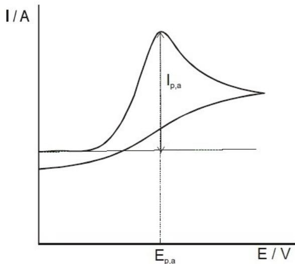
**Slika 11.** Ciklički voltamogram ireverzibilne reakcije na površini elektrode.
