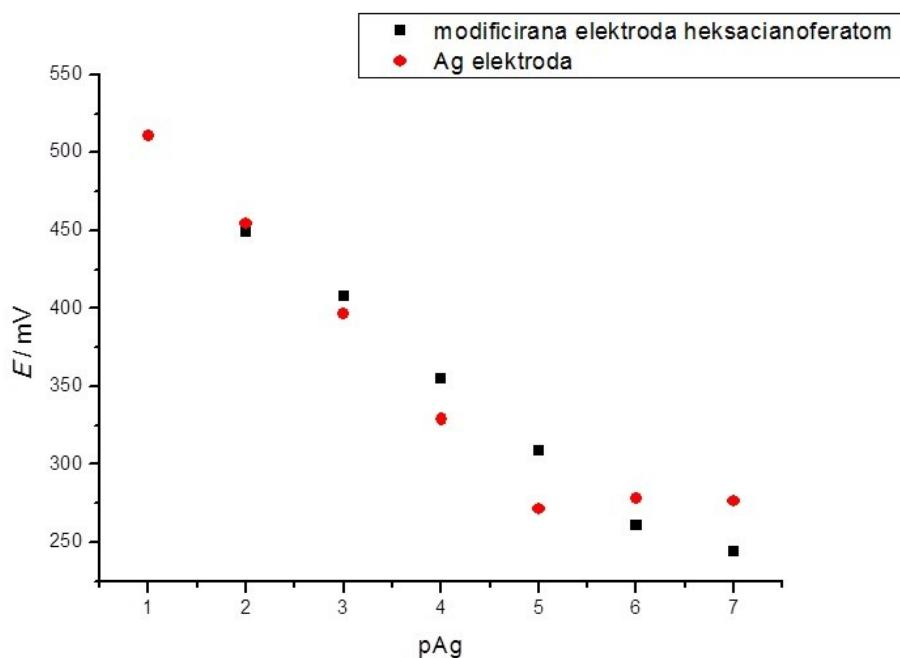
**Slika 19.** Usporedba odziva Ag-elektrode i Ag-elektrode modificirane heksacianoferatom na  $\text{SO Ag}^+$ -iona podešene ionske jakosti.
