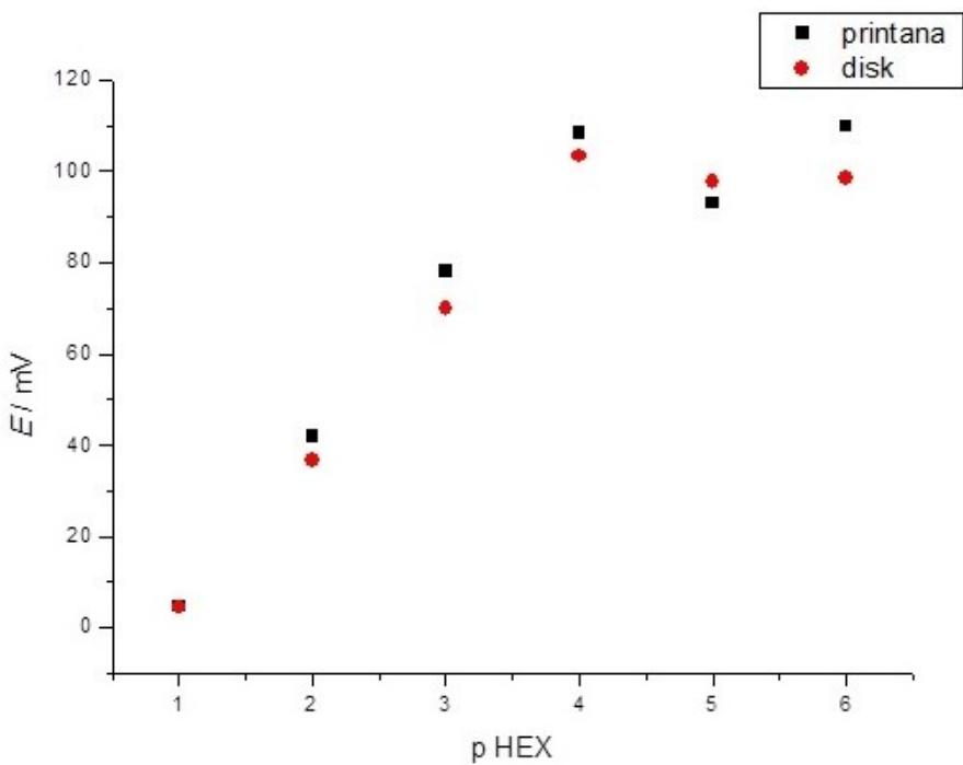
**Slika 26.** Usporedba rezultata baždarenja printane, odnosno disk elektrode modificirane cikličkom voltametrijom pri eksperimentalnim uvjetima navedenim uz Sliku 23.
