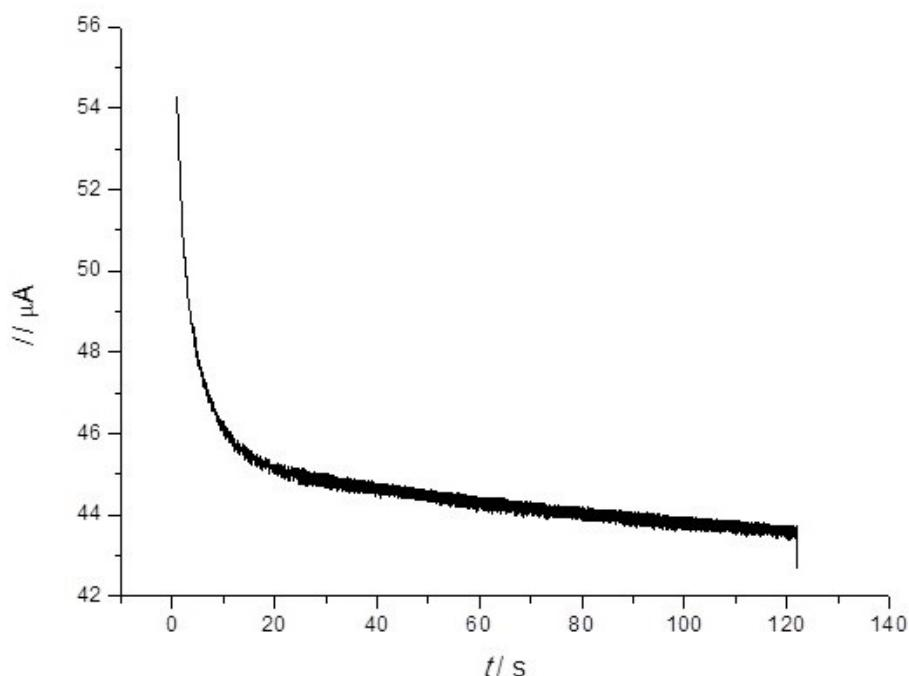
**Slika 28.** Rezultat potenciostatskog oslojavavanja Ag–disk elektrode slojem  $\text{Ag}_4[\text{Fe}(\text{CN})_6]$  u 1 mM otopini  $\text{K}_4[\text{Fe}(\text{CN})_6]$  u 0,1 M  $\text{NaNO}_3$  pri  $E = 0,15$  V i  $t = 2$  min
