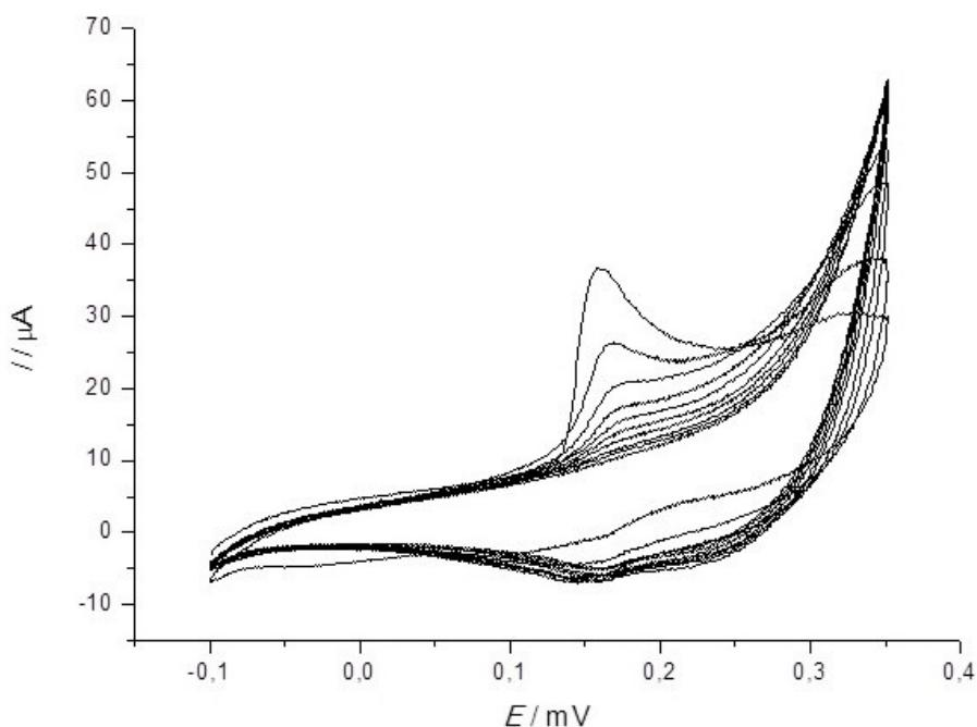
**Slika 23.** Prikaz oslojavanja Ag–disk elektrode promjera 1 mm u 1 mM otopini  $\text{K}_4\text{Fe}(\text{CN})_6$ .
