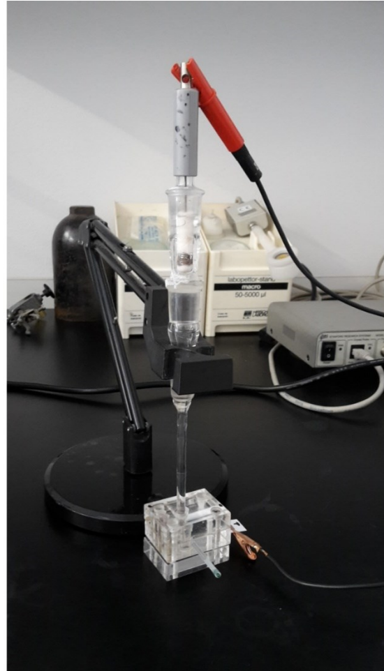
Slika 14. Neprotočna ćelija za potenciometrijsko mjerenje.
