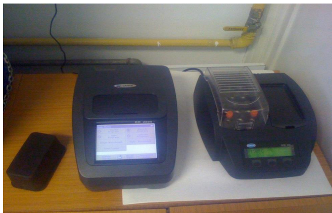
Slika 5. DR 2800 spektrofotometar, Hach Lange (s prijenosnim termoblokom)
