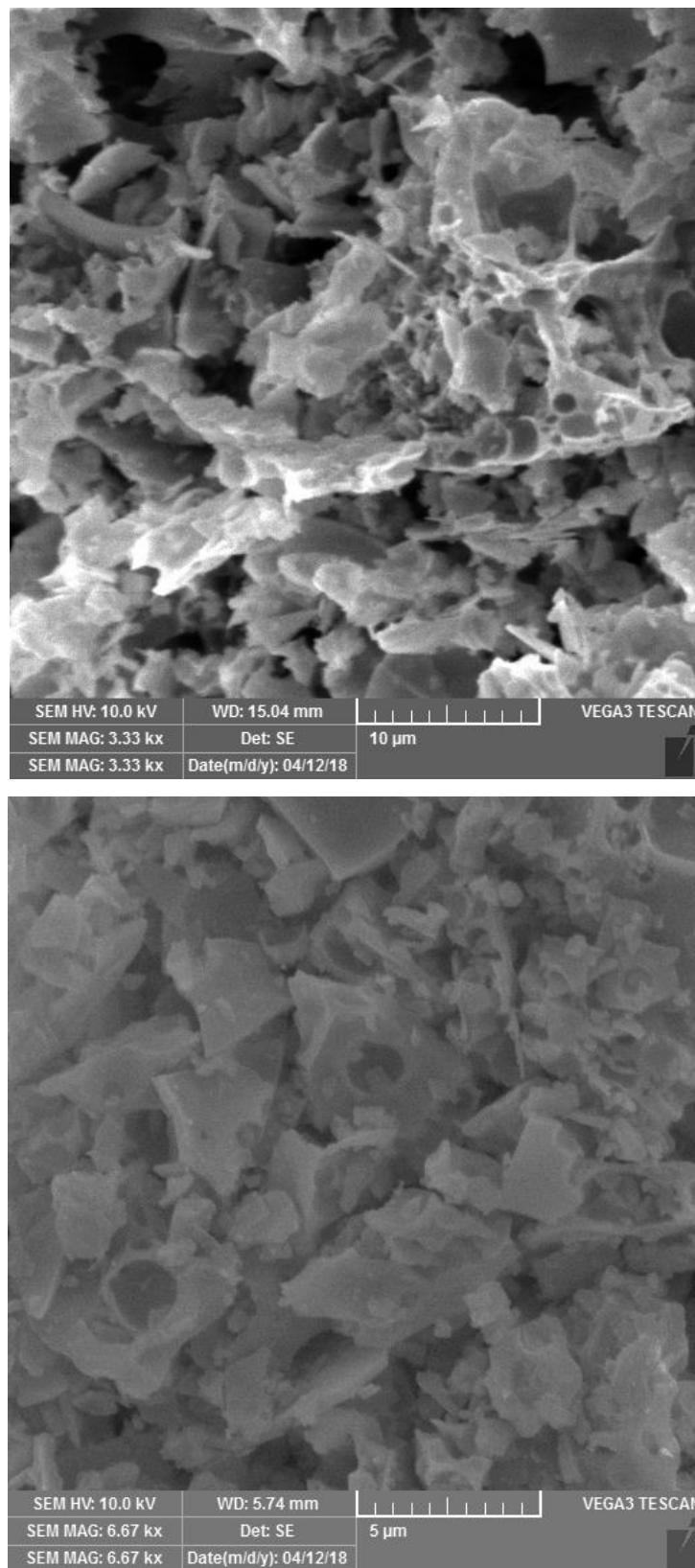
**Slika 7.** SEM mikrografije uzorka N1A1 dobivenog sintezom sagorijevanjem
