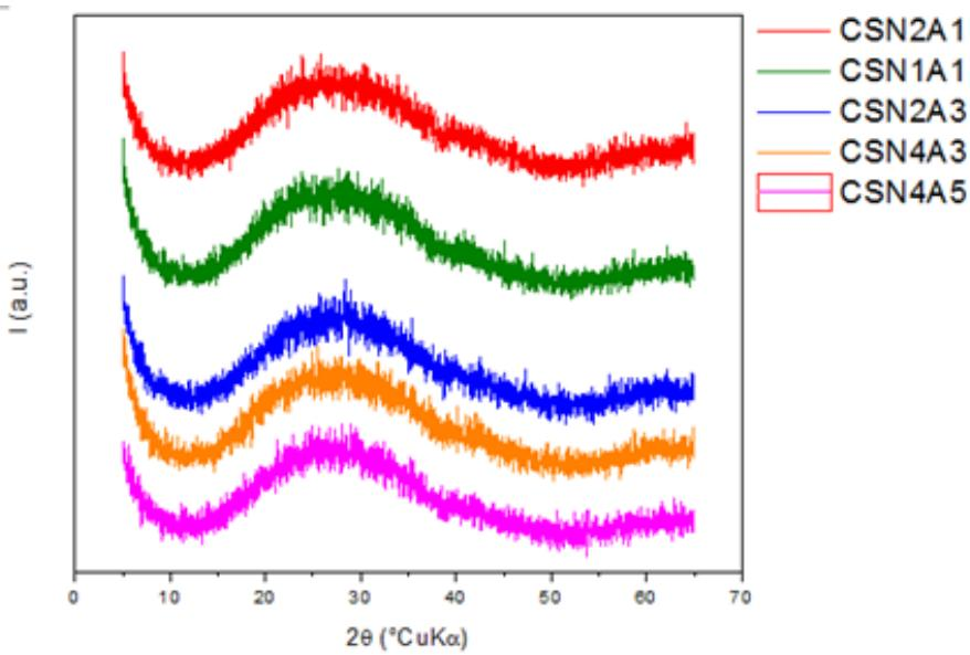
**Slika 13.** Difraktogrami različitih uzoraka nakon toplinske obrade na  $600\text{ }^{\circ}\text{C}$  u trajanju od 2h
