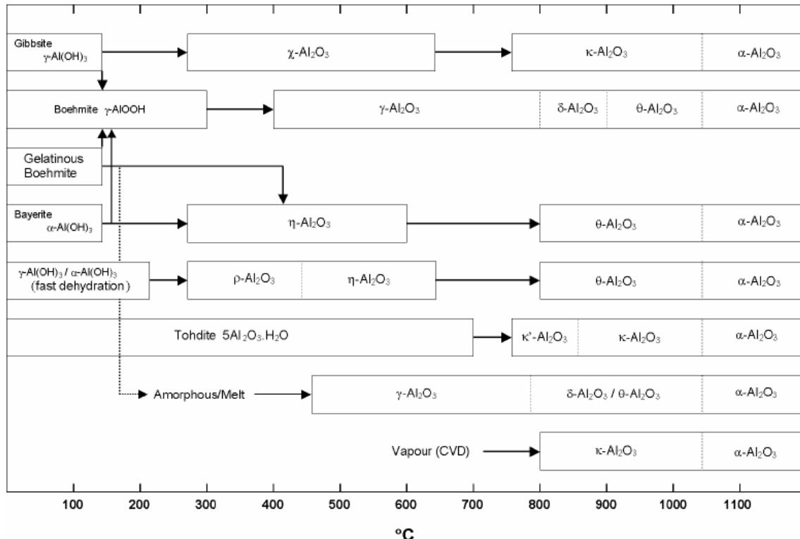
**Slika 1.** Sažetak transformacijskih prijelaza aluminijevih oksida i njihova pojava u procesima kalciniranja<sup>8</sup>
