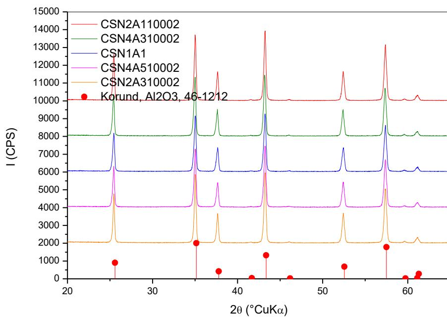
**Slika 17.** Difraktogram uzorka nakon toplinske obrade na 1000 °C u trajanju od 2h
