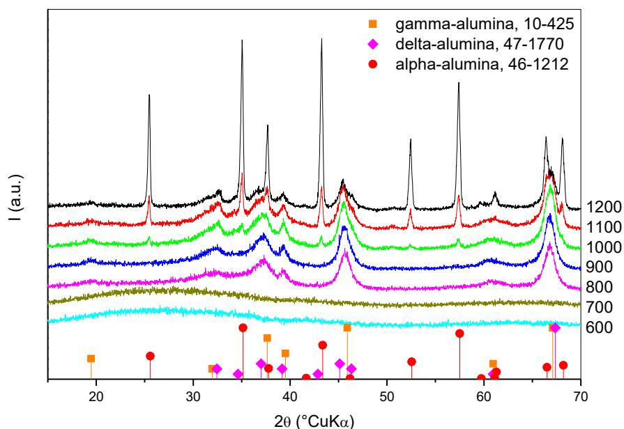
**Slika 11.** Difraktogrami uzorka CSN1A1 zagrijavanog do različitih temperatura
