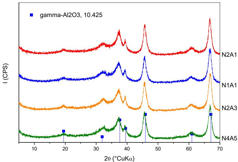
**Slika 14.** Difraktogram uzoraka nakon toplinske obrade na  $800\text{ }^{\circ}\text{C}$  u trajanju od 2h
