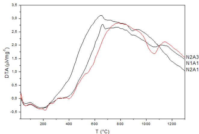
**Slika 8.** a) TG i b) DTA krivulje prašaka dobivenih sintezom sagorijevanjem
