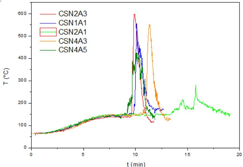
**Slika 5.** Grafički prikaz ovisnosti temperature o vremenu tijekom sinteze sagorijevanjem otopine istraživanih uzoraka
