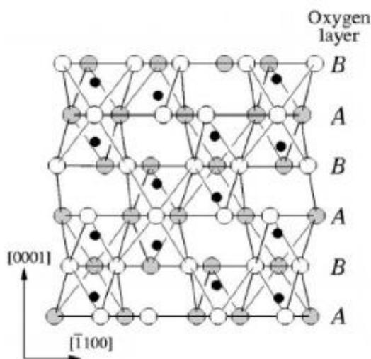
Slika 3. Kristalna struktura  $\alpha\text{-Al}_2\text{O}_3$ <sup>15</sup>
