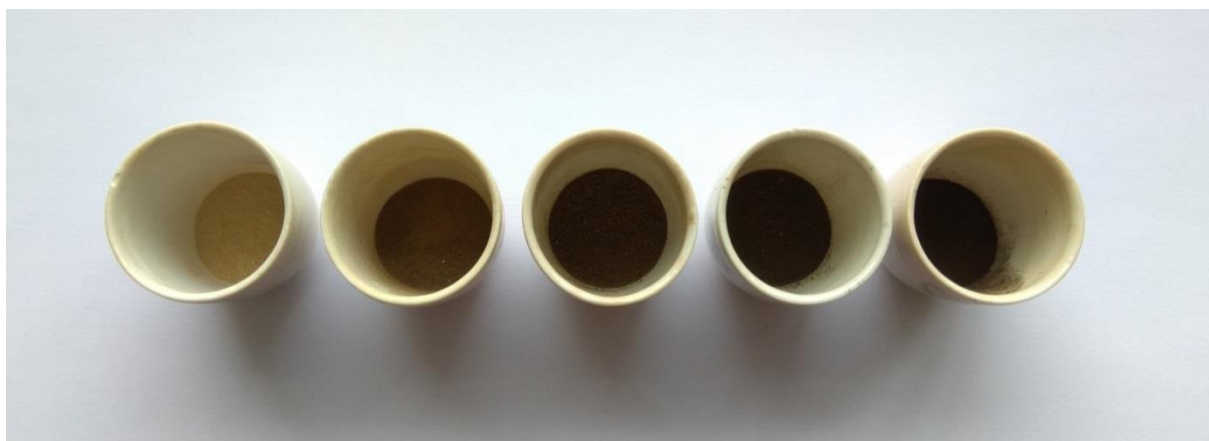
Slika 9. Prašci dobiveni izravno sintezom sagorijevanjem otopine bez naknadne toplinske obrade u različitim omjerima oksidansa i goriva (uzorci redom s lijeva na desno: CSN2A1, CSN4A3, CSN1A1, CSN4A5, CSN2A3)
