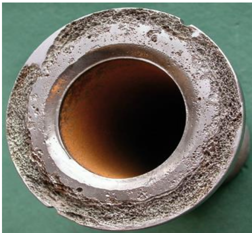
Slika 8. Prikaz korozijskog oštećenja uslijed korozije u zazoru [20] .
