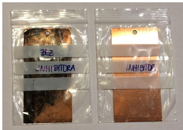
Slika 3.14. Uzorci za FTIR.
