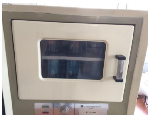
Slika 3.5. Sušionik Instrumentaria Zagreb ST-01/02.
