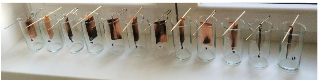
**Slika 3.13.** Sušenje bakrenih pločica.
