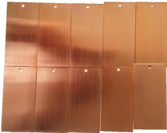
**Slika 3.12.** Bakrene pločice nakon odmašćivanja u ultrazvučnoj kupelji.
