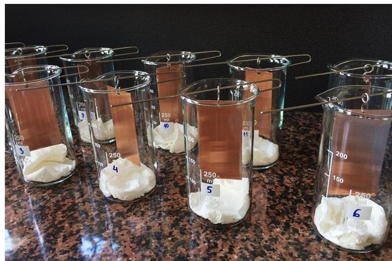
**Slika 3.8.** Sušenje bakrenih pločica.
