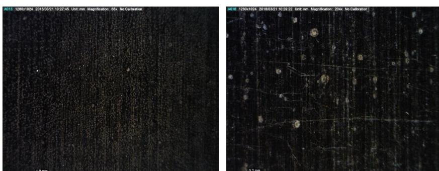
**Slika 4.10.** Površina bakrene pločice zaštićene inhibitorom (I28) pri povećanju  $P = 65 X$  i
