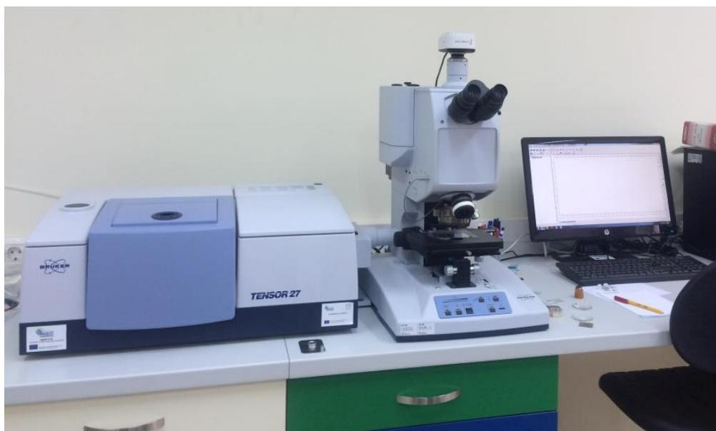
**Slika 3.7.** FT-IR spektrometar.
