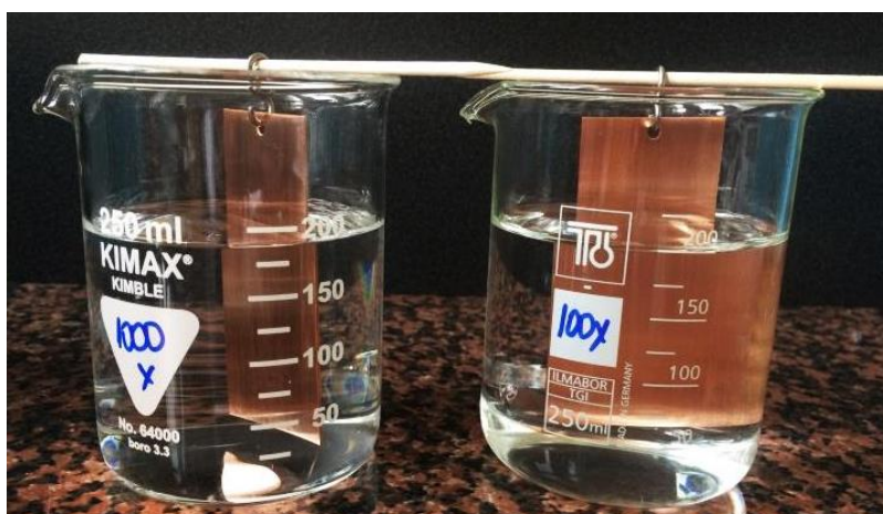
Slika 3.9. Uranjanje bakrenih pločica u razrijeđenim otopinama NaCl-a.
