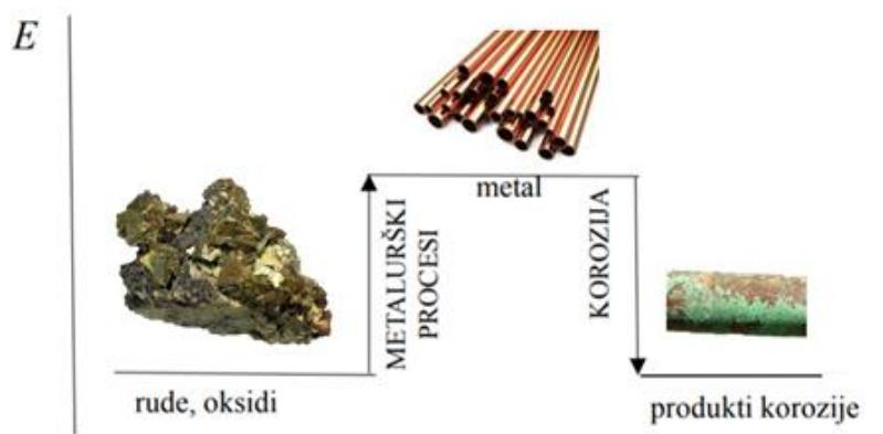
**Slika 2.3.** Prikaz energetskih promjena pri dobivanju i koroziji metala [10, 11, 12, 13].
