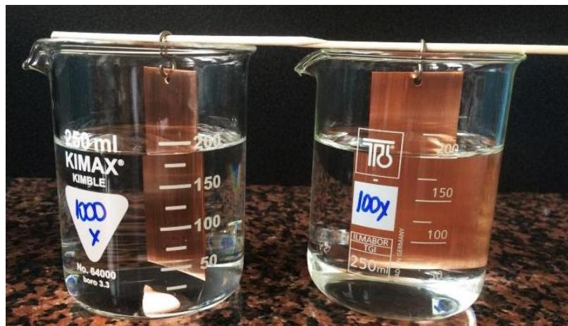
**Slika 3.9.** Uranjanje bakrenih pločica u razrijeđenim otopinama NaCl-a.
