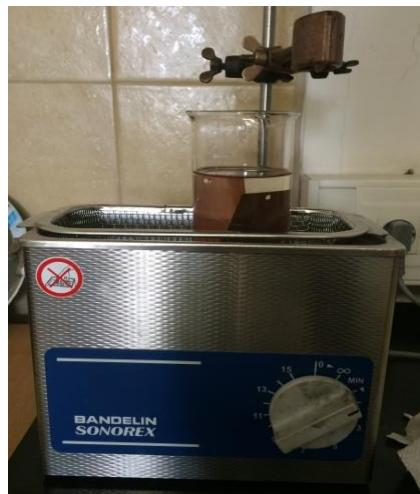
**Slika 3.4.** Ultrazvučna kupelj.
