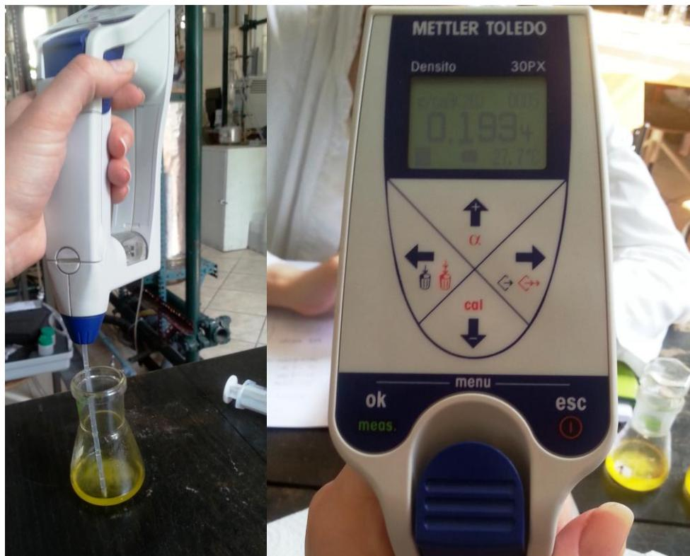
Slika 14. Uređaj za mjerjenje gustoće kapljevina - *METTLER TOLEDO Densito 30PX*
