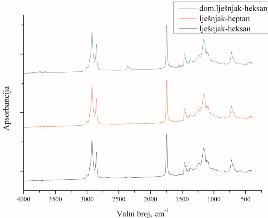
Slika 25. FTIR spektar uzorka ulja ekstrahiranog iz mljevenog lješnjaka
