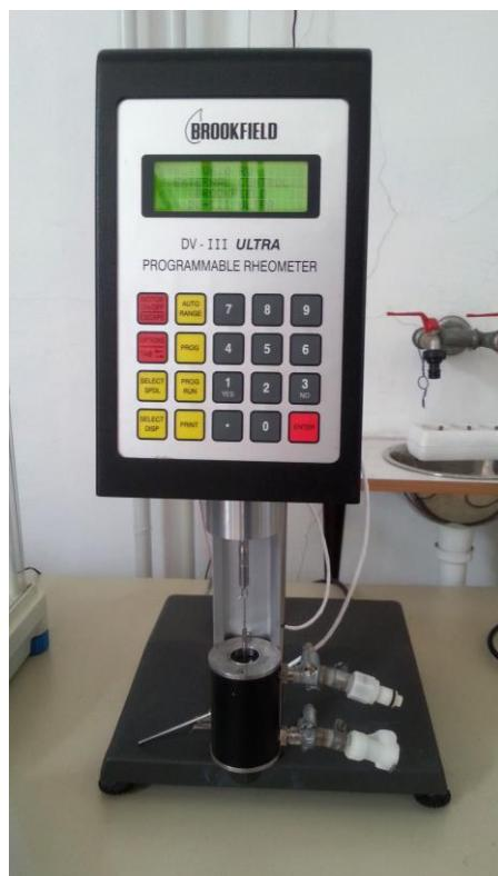
Slika 15. Rotacijski viskozimetar *Brookfield DV – III ULTRA*
