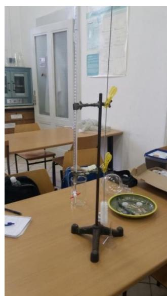
Slika 14. Aparatura za titraciju
