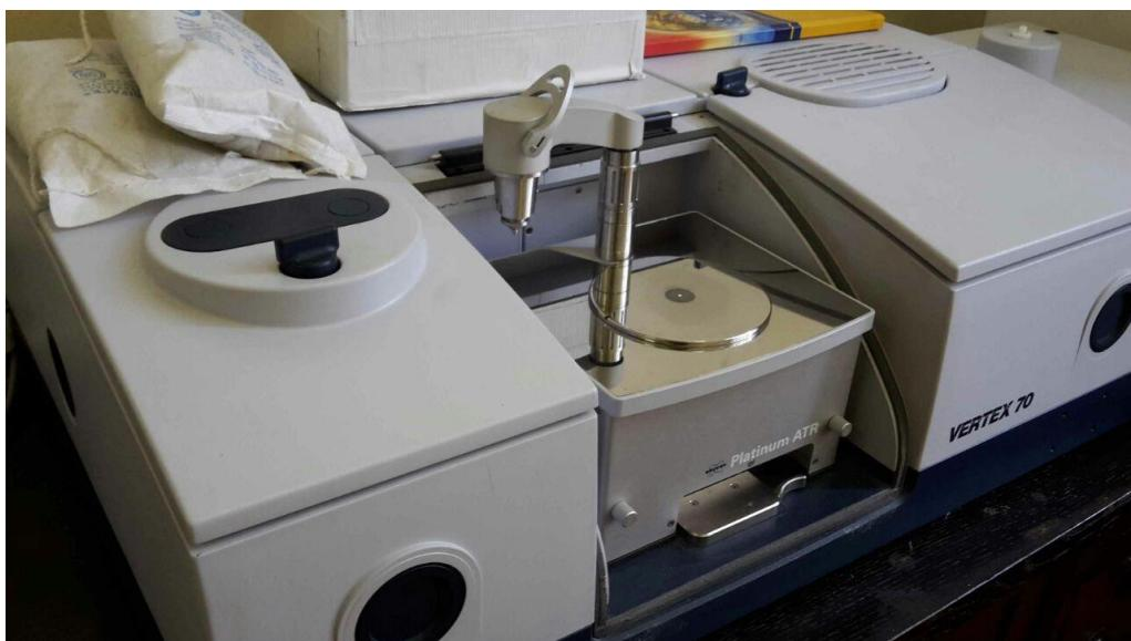
Slika 16. Uređaj za FTIR analizu- *Bruker Vertex 70*
