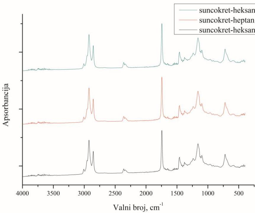
Slika 27. FTIR spektar uzoraka ulja ekstrahiranog iz mljevenog suncokreta
