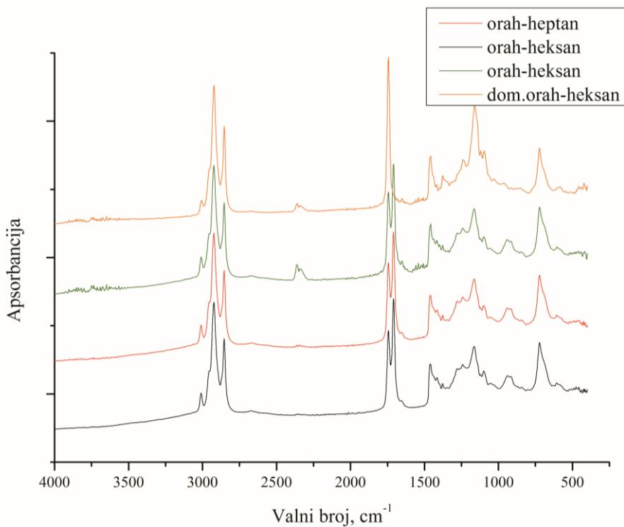
Slika 24. FTIR spektar uzorka ulja ekstrahiranog iz mljevenog oraha
