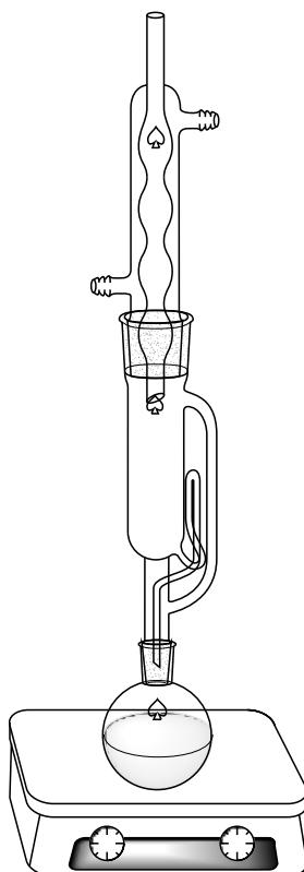
Slika 7. Soxhlet-ov ekstraktor
