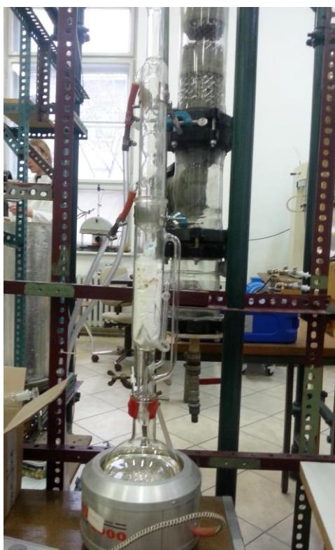
Slika 12. Aparatura za ekstrakciju po Soxhletu
