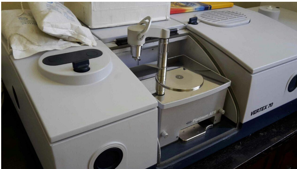
Slika 16. Uređaj za FTIR analizu- Bruker Vertex 70
