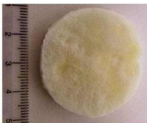
Slika 4. CS spužva dobivena procesom liofilizacije (preuzeto iz [17]).
