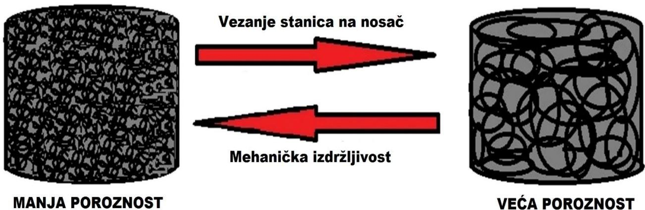
Slika 2. Odnos poroznosti biomaterijala – nosača, bioaktivnosti i mehaničkih svojstava [6].
