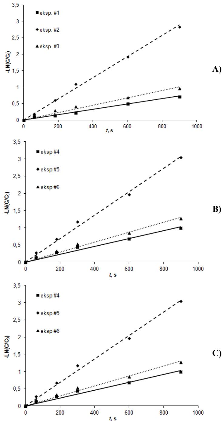
**Slika 6.** Grafičko određivanje konstanti prvog reda za razgradnju modelnog onečišćivala u istraživanom vremenu obrade UV-C/H<sub>2</sub>O<sub>2</sub> procesom pri procesnim uvjetima danim u Tablici 5.
