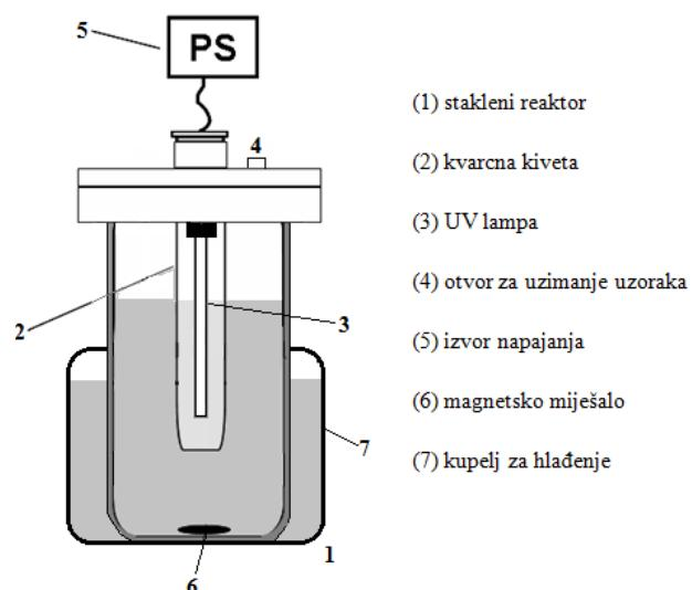
Slika 5. Shema reaktora
