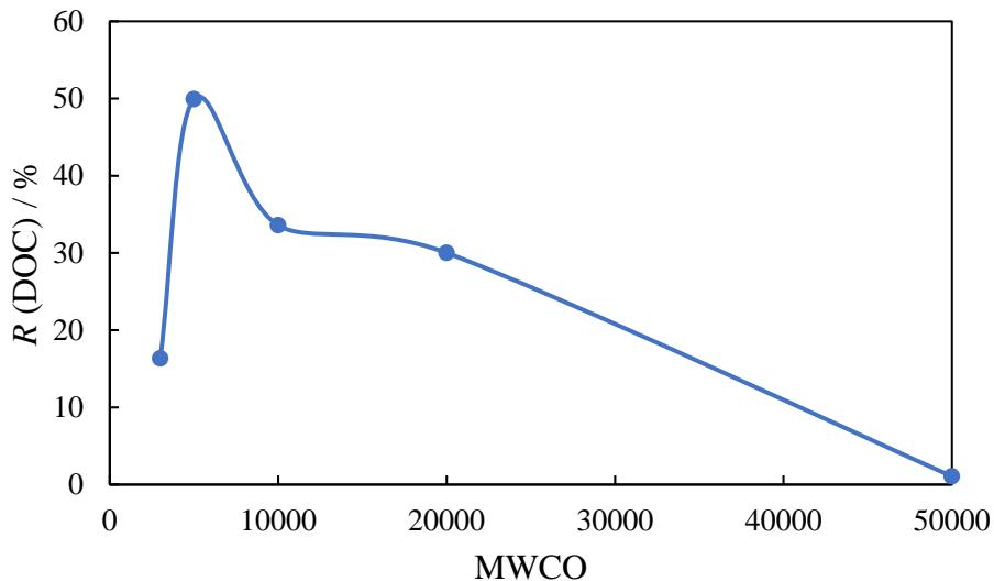
*Slika 4.11.* Prikaz ovisnosti  $R$ (DOC) o MWCO za ispitivane UF membrane
