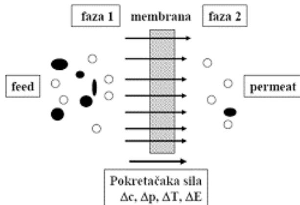
**Slika 2.3.** Shematski prikaz dvofaznog sustava razdvojenog membranom
