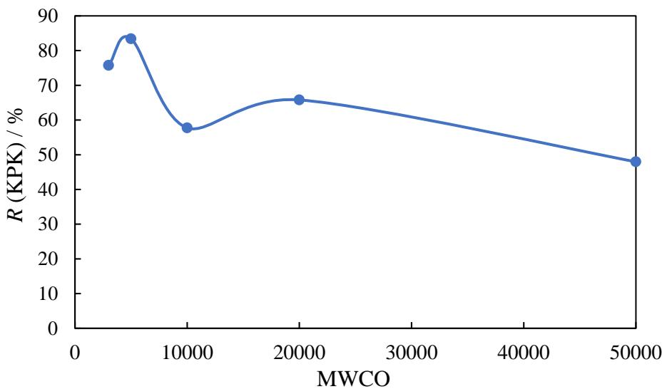
*Slika 4.12.* Prikaz ovisnosti  $R$ (KPK) o MWCO za ispitivane UF membrane
