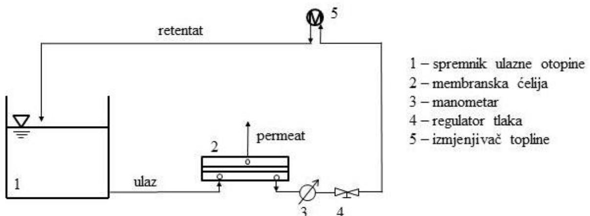
*Slika 3.2.* Aparatura za ultrafiltracijsku obradu
