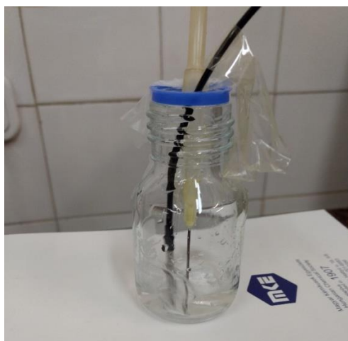
Slika 3.7. Schottova boca s kisikovom elektrodom i iglom za upuhivanje dušika
