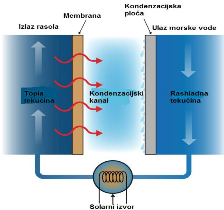
**Slika 16.** Shematski prikaz procesa membranske destilacije [8].
