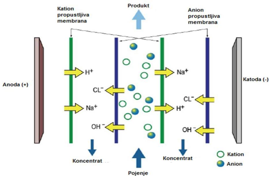
**Slika 12.** Prikaz ionske izmjene u procesu elektrodijalize [8].
