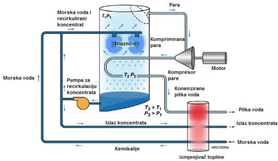
Slika 9. Shematski prikaz desalinacijskog postrojenja s mehaničkom kompresijom pare [2].
