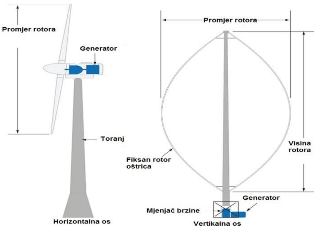
Slika 22. Vjetroturbine sa horizontalnom i vertikalnom osi [2].
