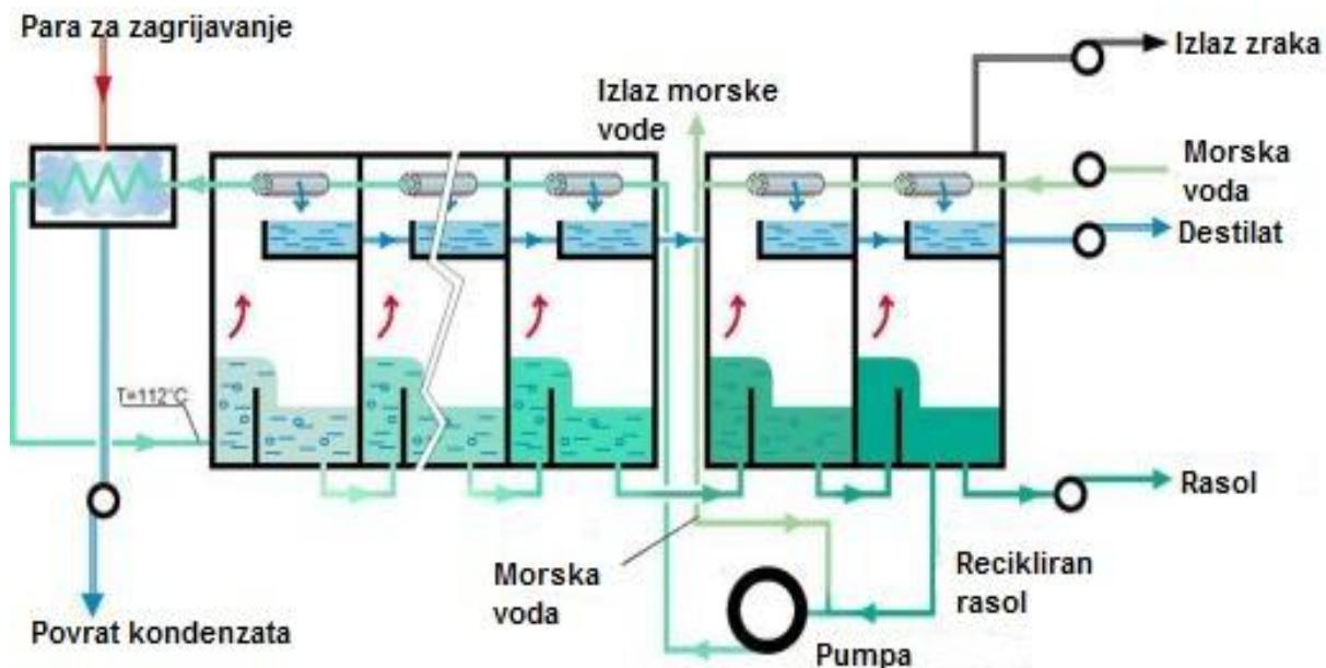
**Slika 7.** Višestupnjevita flash destilacija sa recirkulirajućim rasolom [6].
