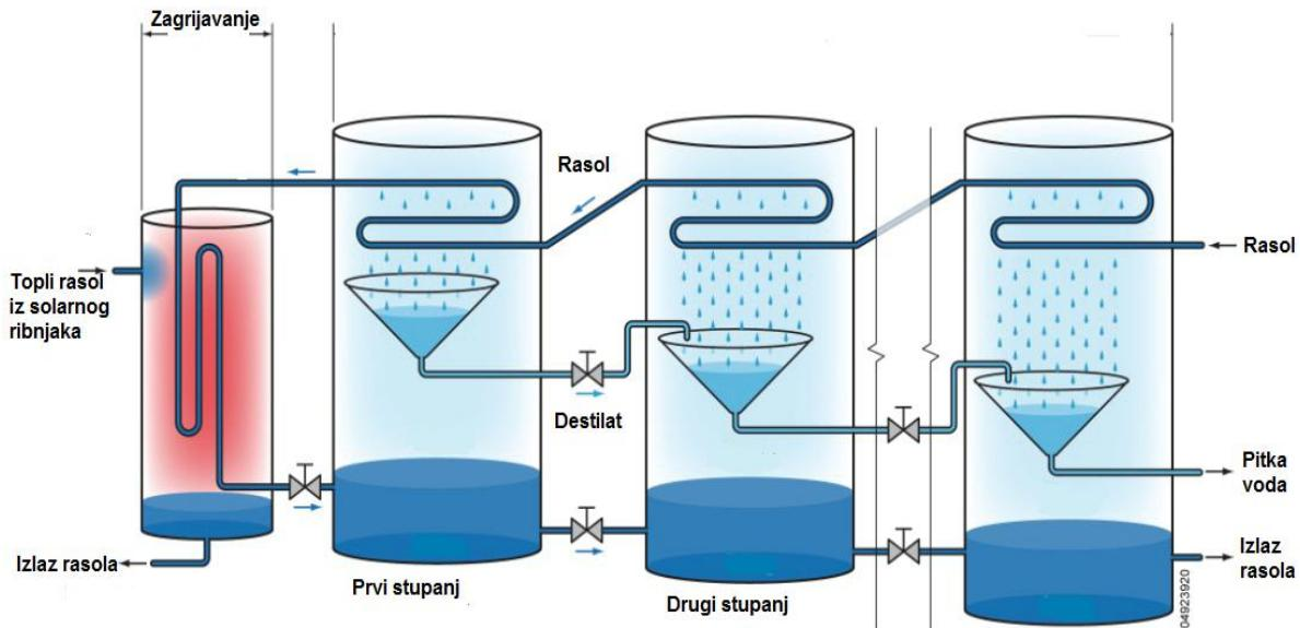
**Slika 17.** MSF desalinacijsko postrojenje pokretano solarnim ribnjakom [8].
