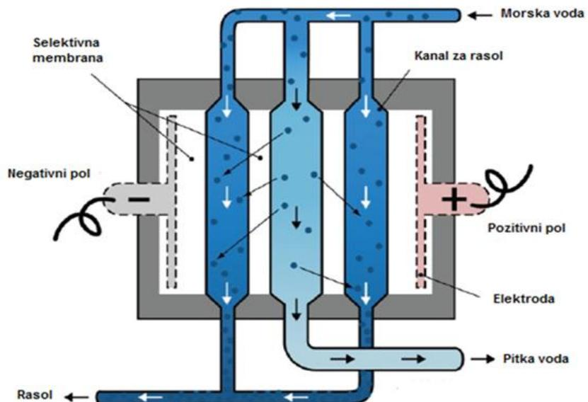
**Slika 13.** Shematski prikaz desalinacijskog postrojenja koje koristi elektrodijalizu [8].
