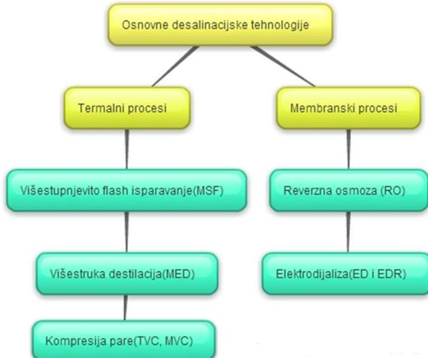
Slika 5. Shematski prikaz osnovnih desalinacijskih tehnologija [2].
