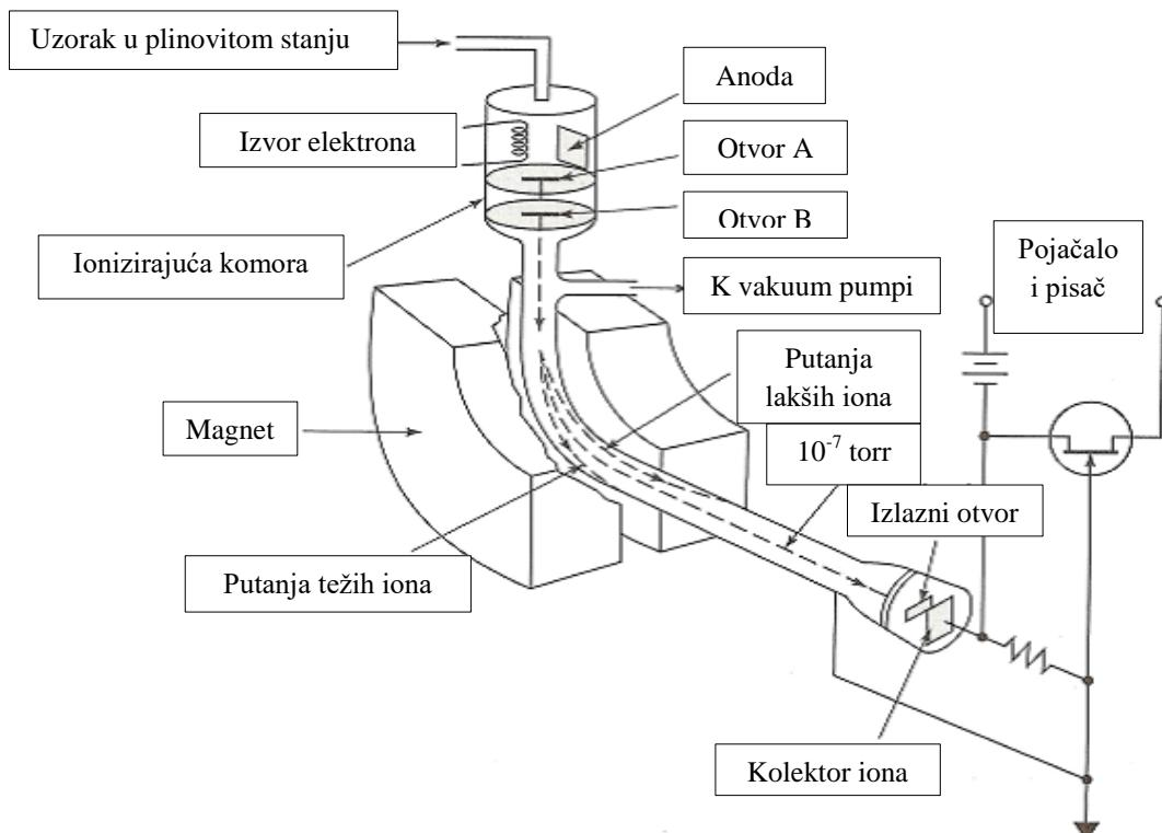
Slika 10. Shematski prikaz rada masenog spektrometra (MS)
