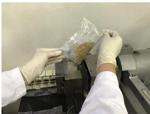
Slika 3.11. Priprema LDPE/RLJ kompozita u Brabender gnjetilici.
