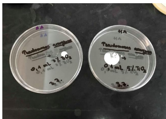
Slika 3.10. Određivanje prijenosa antimikrobnih sastojaka prema Normi EN ISO 846:1997 54 u pokusu P2
