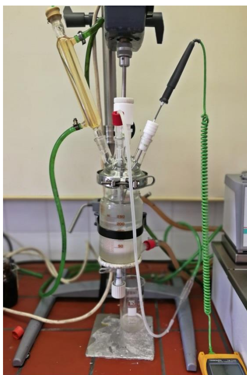
Slika 14. Fotografija i shema aparature za polimerizaciju
