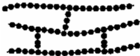
Slika 3. Shematski prikaz umrežene makromolekule
