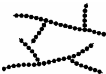
Slika 2. Shematski prikaz granatih makromolekula
