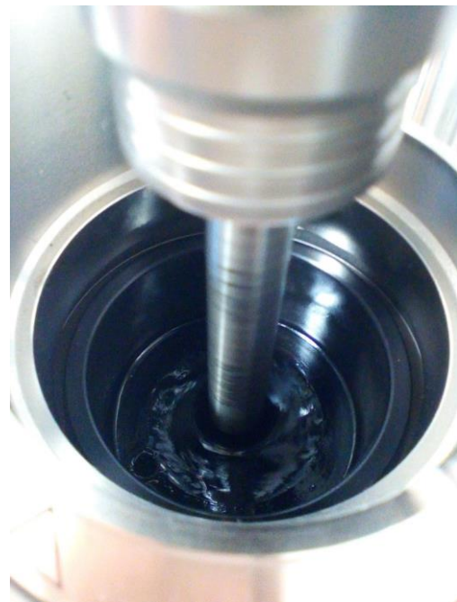
Slika 3.3. Uzorak u posudi za vrijeme reoloških ispitivanja
