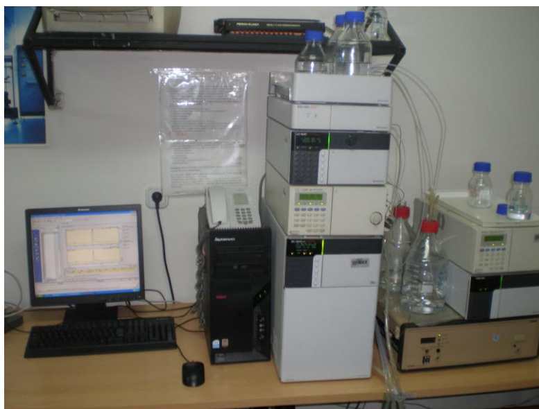
Slika 5. HPLC korišten za određivanje koncentracije fenola
