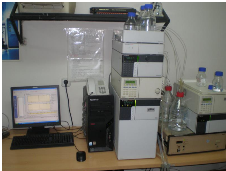
Slika 5. HPLC korišten za određivanje koncentracije fenola
