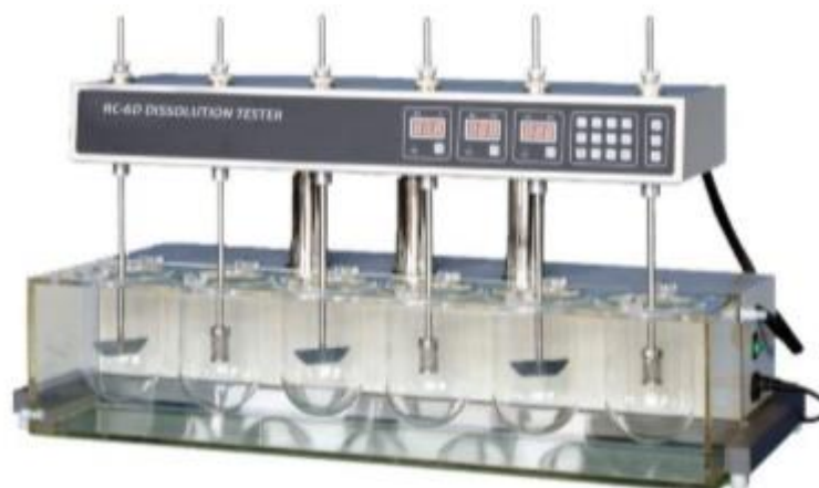
Slika 22. Uređaj za ispitivanje oslobađanja djelatnih tvari (RC-6D, Zhengzhou Nanbei Instrument)
