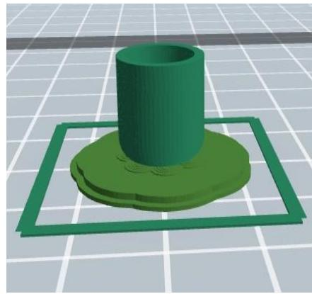
**Slika 19.** Kut tiskanja  $180^\circ$
