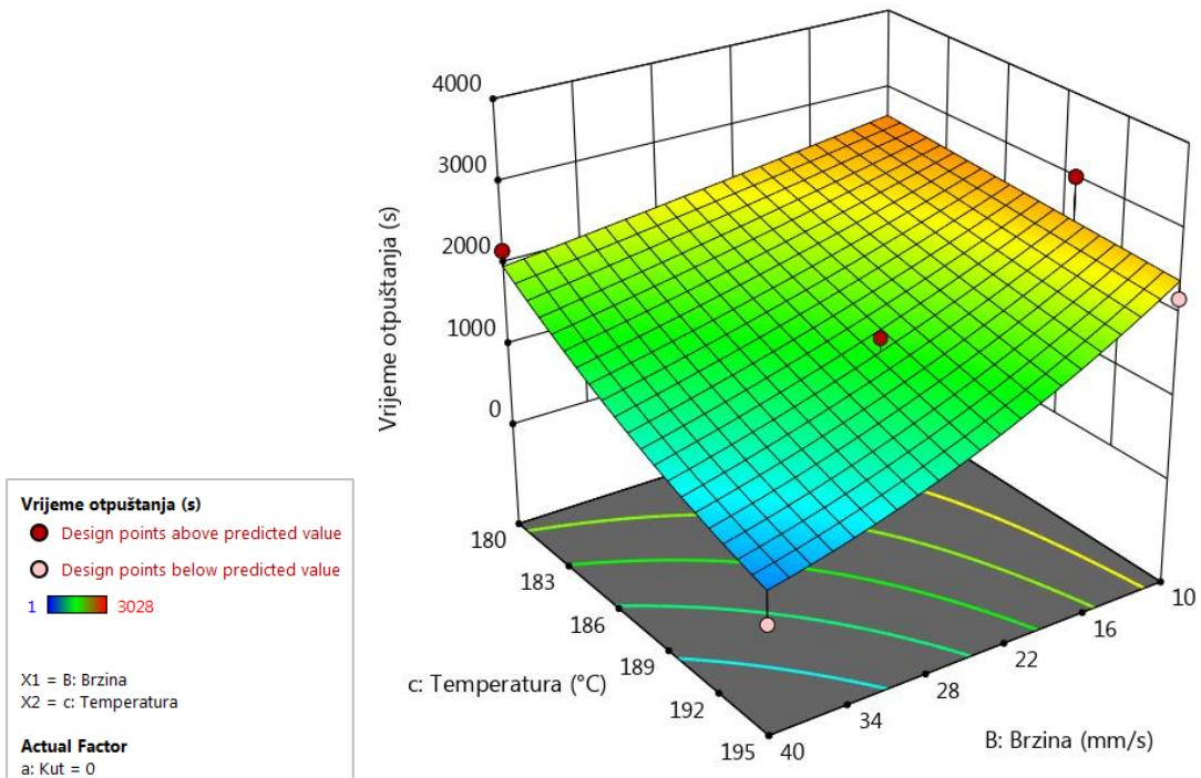
**Slika 34.** Utjecaj temperature ekstrudera i brzine tiskanja na vrijeme otpuštanja (kut, 0°)
