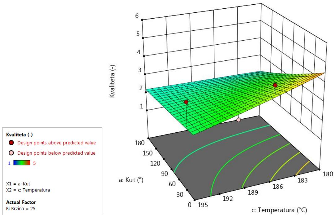
**Slika 36.** Utjecaj temperature ekstrudera i kuta na kvalitetu opne (brzina,  $25 \text{ mm s}^{-1}$ )
