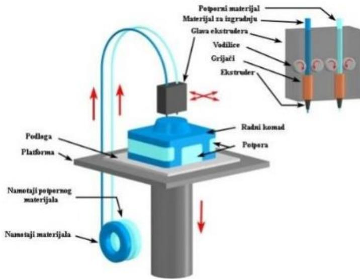
**Slika 3.** Princip FDM tehnologije
