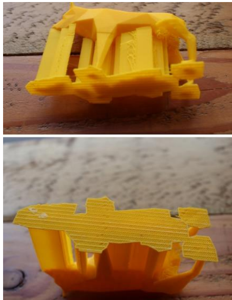
Slika 9. Prikaz 3D-tiskanog modela s opcijom raft
