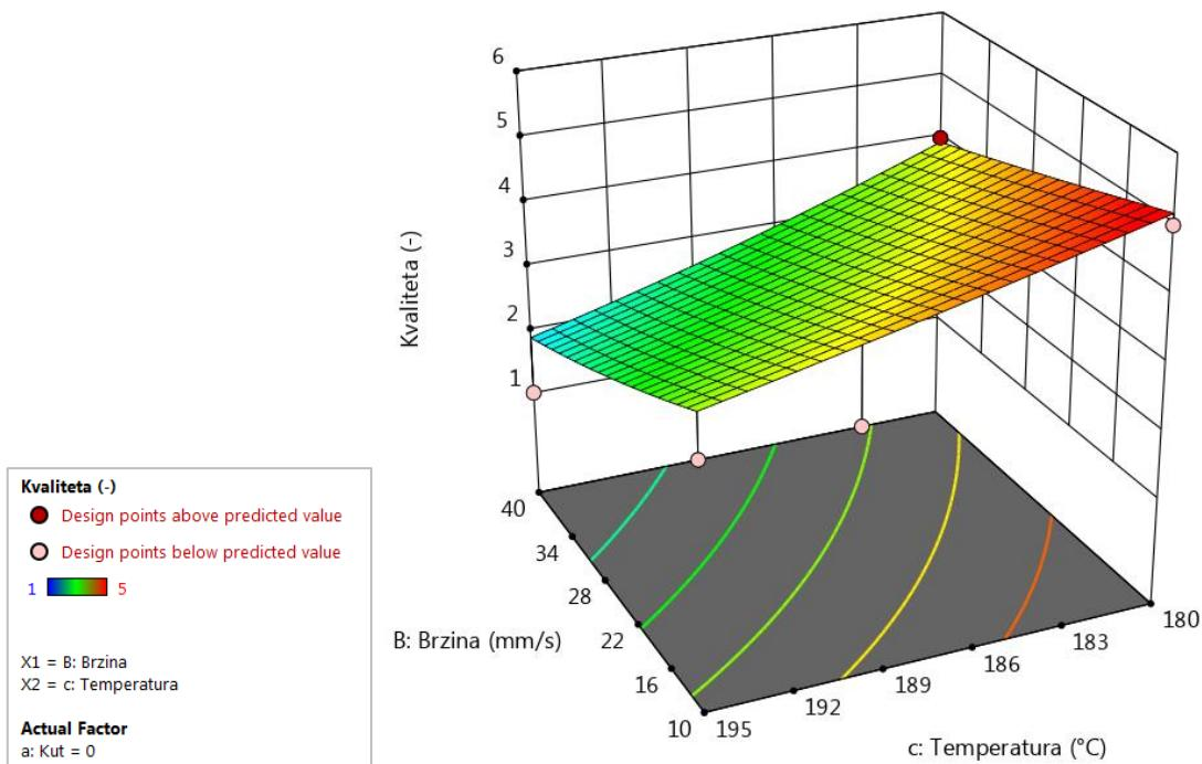
**Slika 37.** Utjecaj temperature ekstrudera i brzine tiskanja na kvalitetu opne (kut, 0°)
