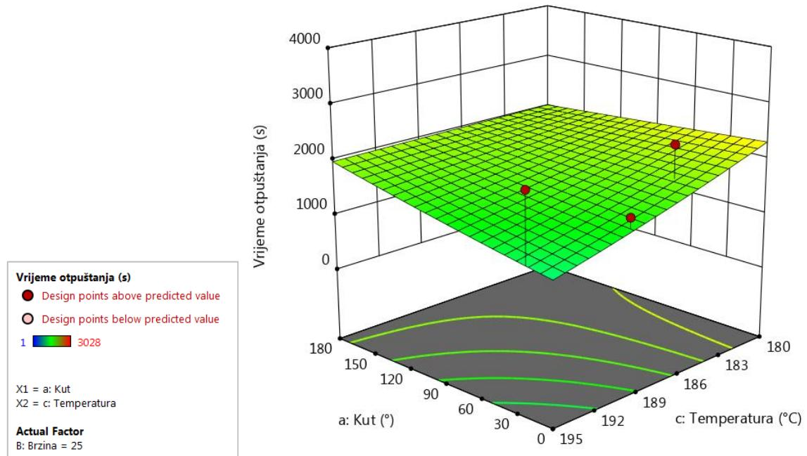
**Slika 33.** Utjecaj temperature ekstrudera i kuta na vrijeme otpuštanja (brzina,  $25 \text{ mm s}^{-1}$ )
