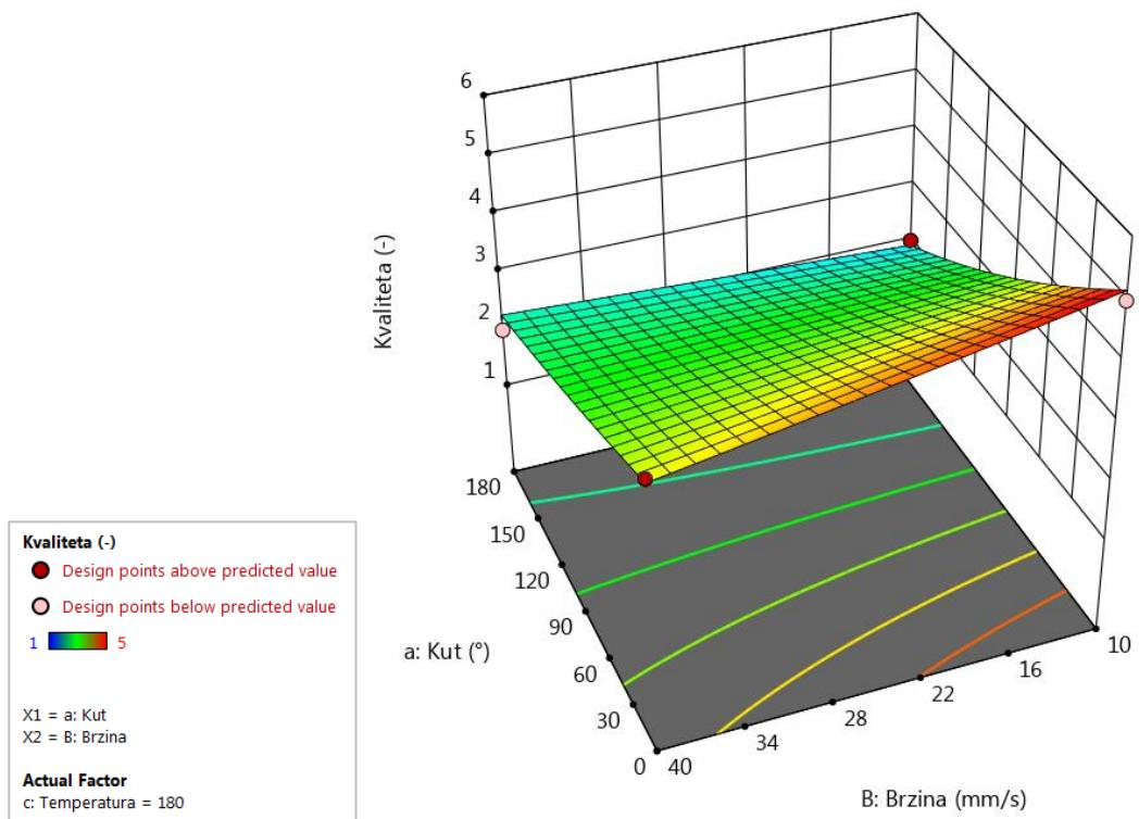
**Slika 35.** Utjecaj brzine tiskanja i kuta na kvalitetu opne ( $T = 190 \text{ } ^{\circ}\text{C}$ )
