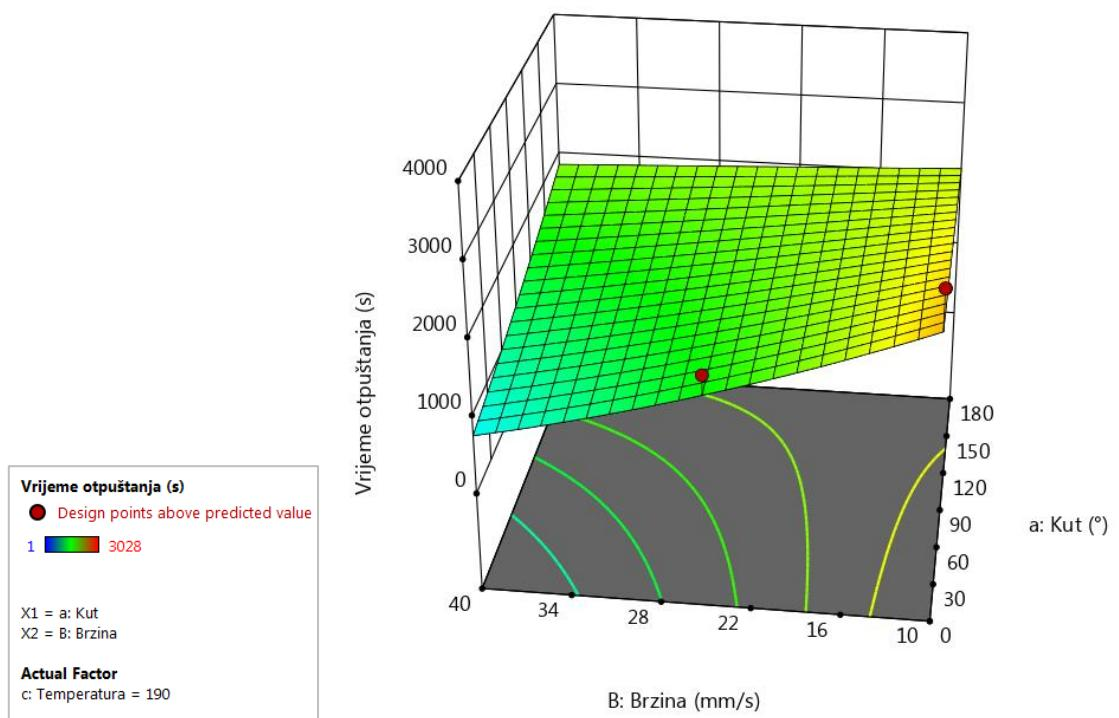
**Slika 32.** Utjecaj brzine tiskanja i kuta na vrijeme otpuštanja iz kapsula ( $T = 190 \text{ } ^{\circ}\text{C}$ )
