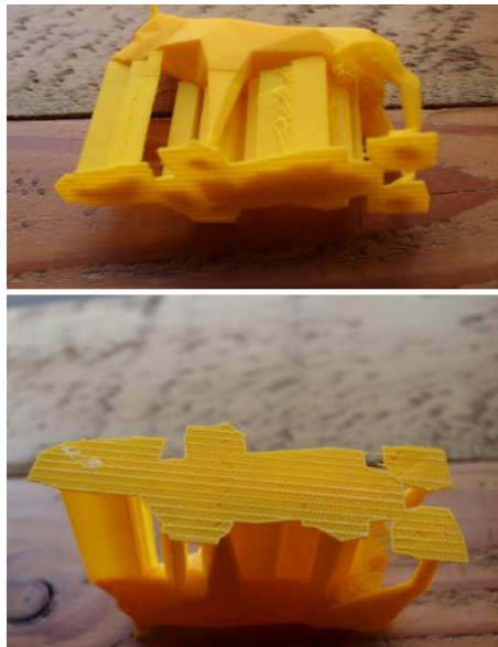
Slika 9. Prikaz 3D-tiskanog modela s opcijom raft
