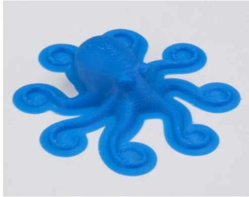
Slika 10. Prikaz 3D-tiskanom modela s opcijom brim
