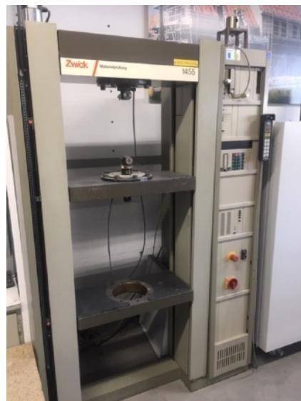
**Slika 19.** Mehanička kidalica Zwick 1455
