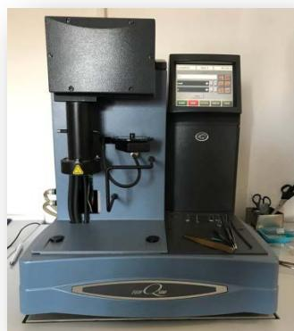
**Slika 18.** Termogravimetar, Q500 TA Instruments
