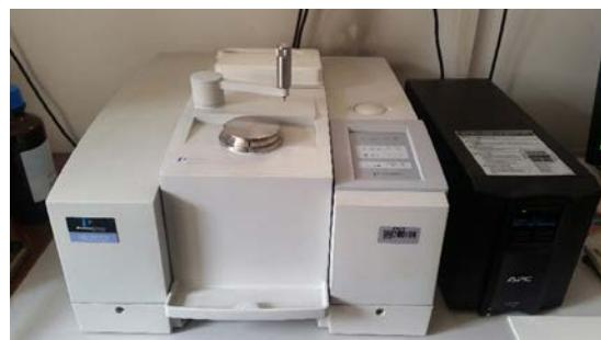
**Slika 20.** FTIR-ATR spektrofotometar Spectrum One, Perkin Elmer
