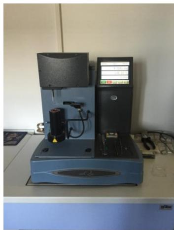
**Slika 3.8.** TGA Q 500 2910 (TA Instruments)<sup>9</sup>
