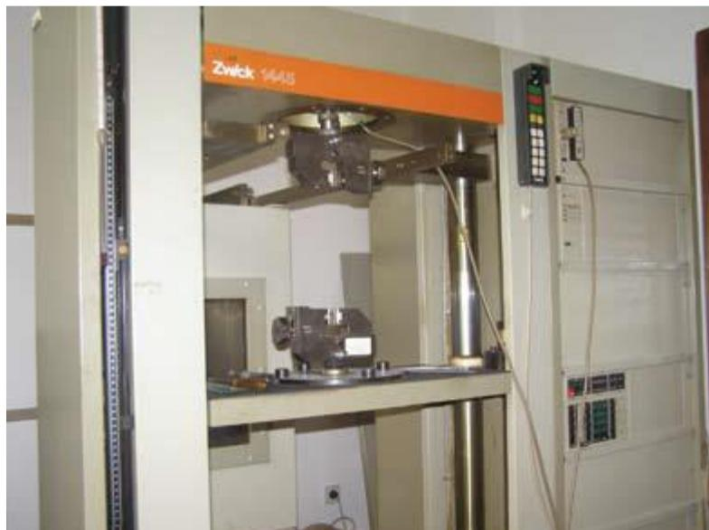
**Slika 3.12.** Univerzalna mehanička kidalica ZWICK/RÖEL UTM 1445<sup>9</sup>
