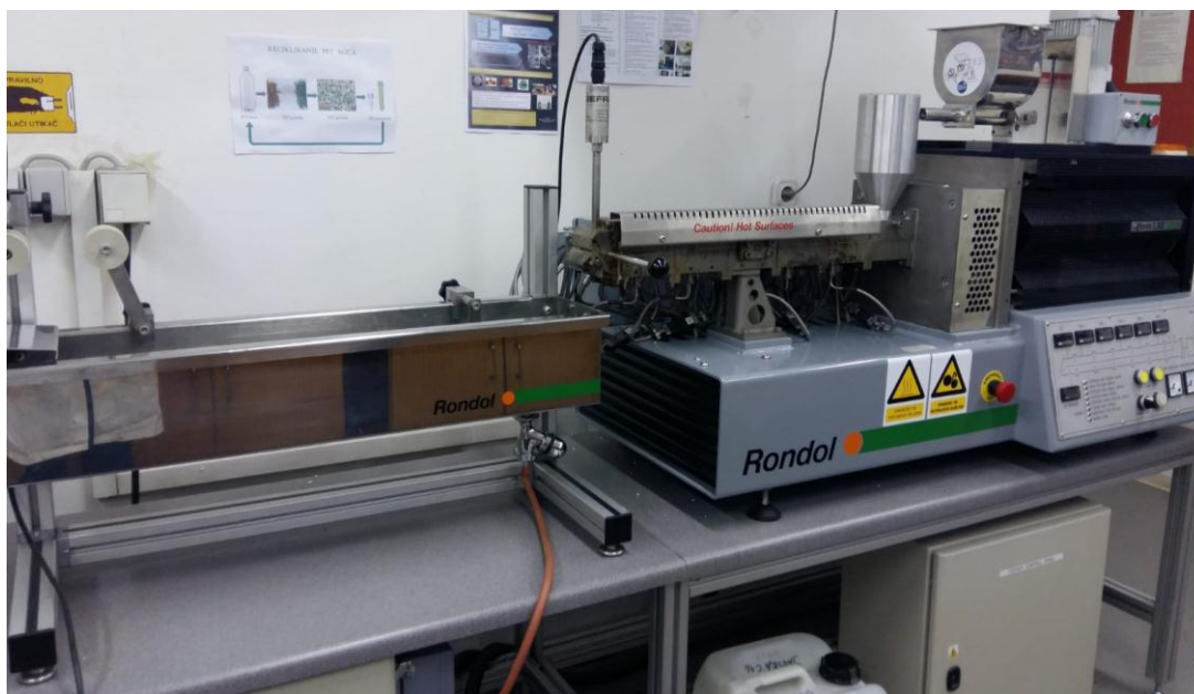
Slika 22. Dvopužni ekstruder Rondol 21 mm LAB TWIN
