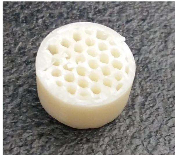
Slika 48. Prikaz 3D-modela i konačnog proizvoda sačaste strukture, 40 %-tne gustoće punjenja
