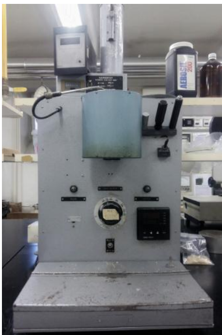
Slika 27. Uređaj za određivanje masenog protoka taljevine
