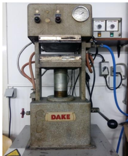
Slika 25. Hidrauličke preše: a) Fontune, b) Dake
