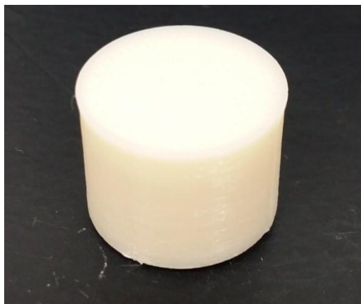
Slika 50. Testni polimerni nosač s formiranom kapicom
