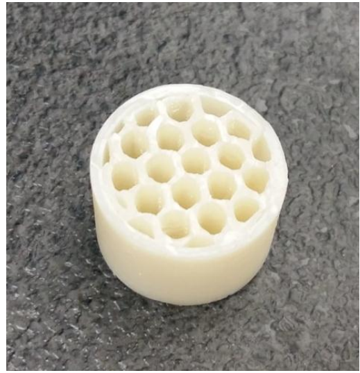
Slika 47. Prikaz 3D-modela i konačnog proizvoda sačaste strukture, 30 %-tne gustoće punjenja
