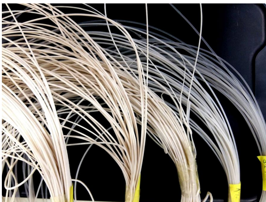
Slika 54. Dobiveni filamenti s različitim masenim udjelima TiO 2 (s lijeva na desno 10 %, 7,5 %, 5 %, 1 % i 0 %)
