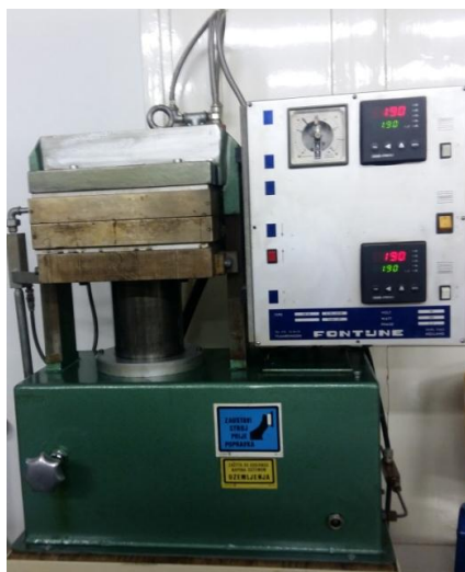
Slika 25. Hidrauličke preše: a) Fontune, b) Dake
