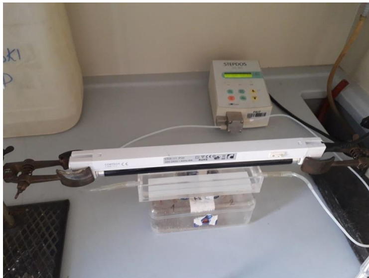
Slika 8: Korištena aparatura za ispitivanje fotokatalitičke aktivnosti.
