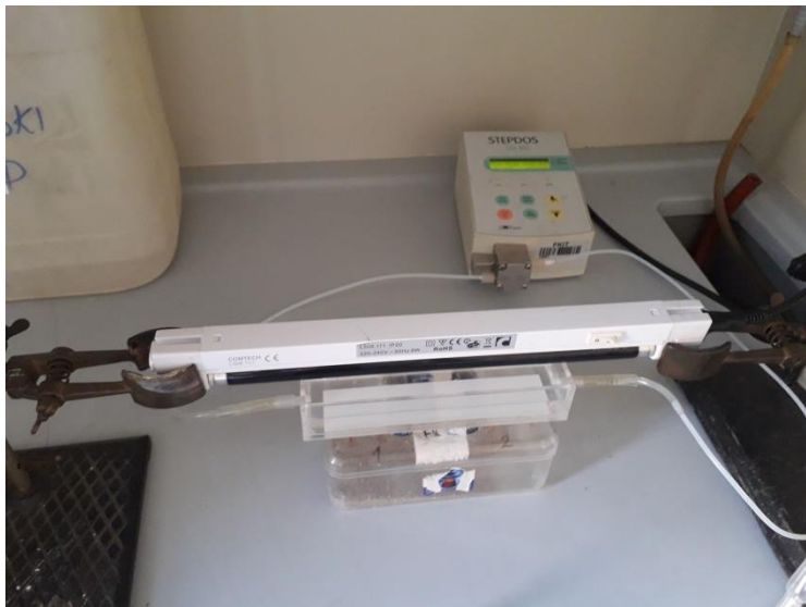
Slika 8: Korištena aparatura za ispitivanje fotokatalitičke aktivnosti.
