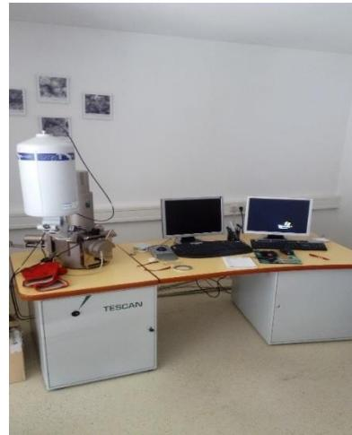
Slika 3.8. SEM uređaj *Tescan Vega 5136 MM*
