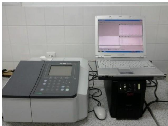
Slika 3.4.. Spektrofotometar *Shimadzu UV-1800*
