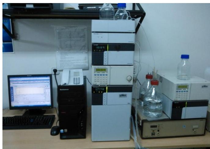
Slika 3.7. HPLC *Shimadzu* modularni sustav
