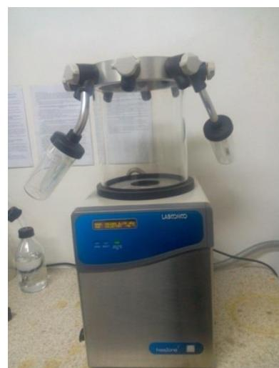
Slika 3.6. Liofilizator *LABCONCO Free Zone*
