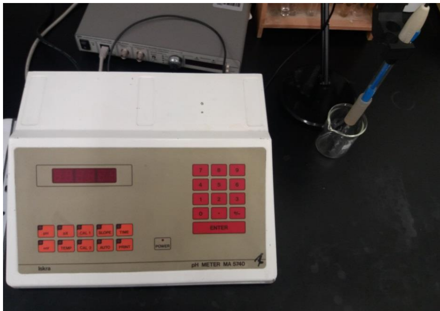
Slika 19. pH metar korišten za dobivanje željene pH vrijednosti puferских otopina
