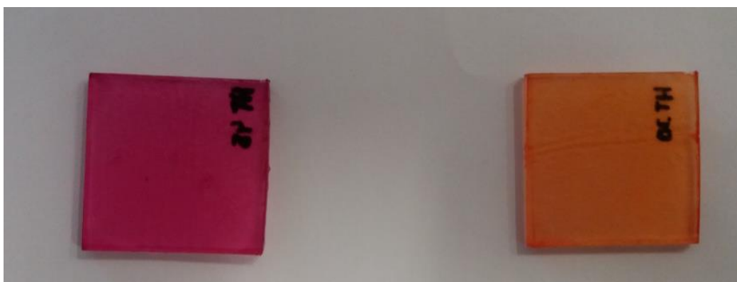
Slika 30. Usporedba filma MTF na pločicama od HT PAK-a nakon kondicioniranja u kiseljoj (lijevo) i lužnatoj (desno) puferskoj otopini
