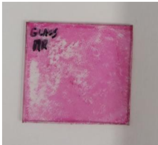
Slika 28. Film MTF na pločici od Z-GLASS-a nakon provedenog preliminarnog ispitivanja otpornosti na grebanje
