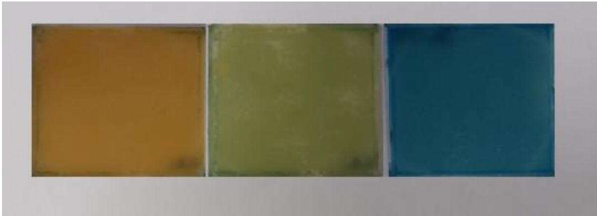
Slika 26. Film BTF na pločici Z-PCABS-a nakon kondicioniranja u kiseljoj (lijevo), neutralnoj (sredina) i lužnatoj (desno) puferskoj otopini
