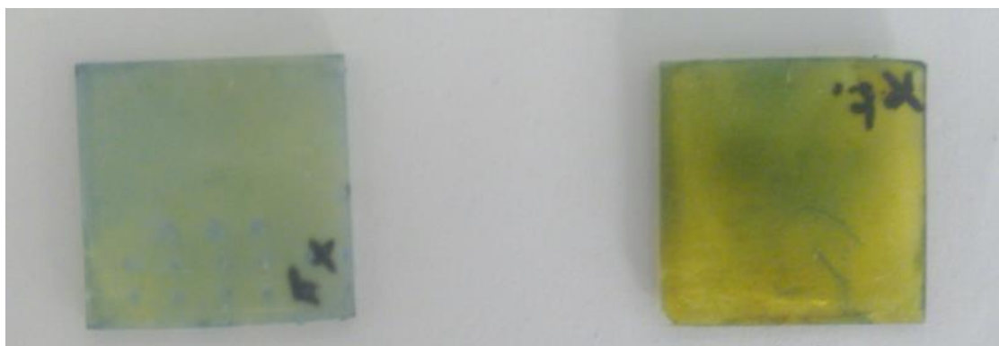
Slika 25. Usporedba nejednolikosti obojenja filma BTF nakon 3 minute kondicioniranja u puferskoj otopini pH=12 na pločici od HT PAK-a (lijevo) i PAK Cleara (desno)
