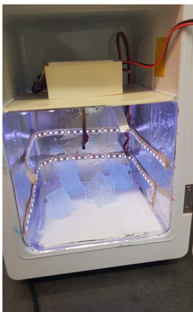
Slika 12. Naknadno očvršćivanje poliakrilatnih pločica
