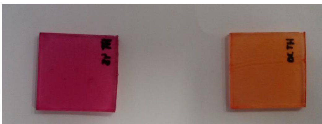
Slika 30. Usporedba filma MTF na pločicama od HT PAK-a nakon kondicioniranja u kiseloj (lijevo) i lužnatoj (desno) puferskoj otopini
