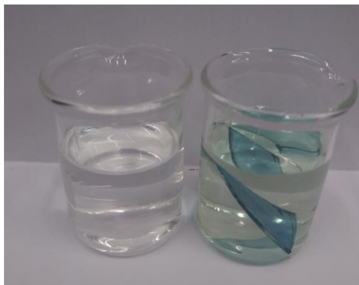
Slika 27. Promjena boje puferske otopine tijekom kondicioniranja filma BTF na pločici od Z-GLASS-a
