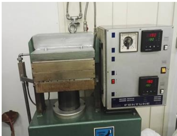
Slika 8. Hidraulička preša korištena za prešanje usitjenih polimernih filamenata
