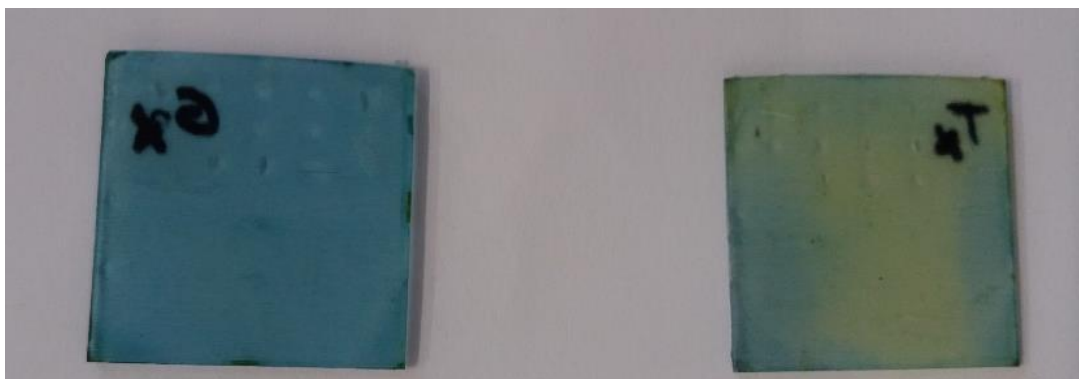
Slika 24. Film BTG na pločici od HT PAK-a (lijevo) i film BT na pločici od HT PAK-a (desno) nakon 3 minute kondicioniranja u puferu pH=12
