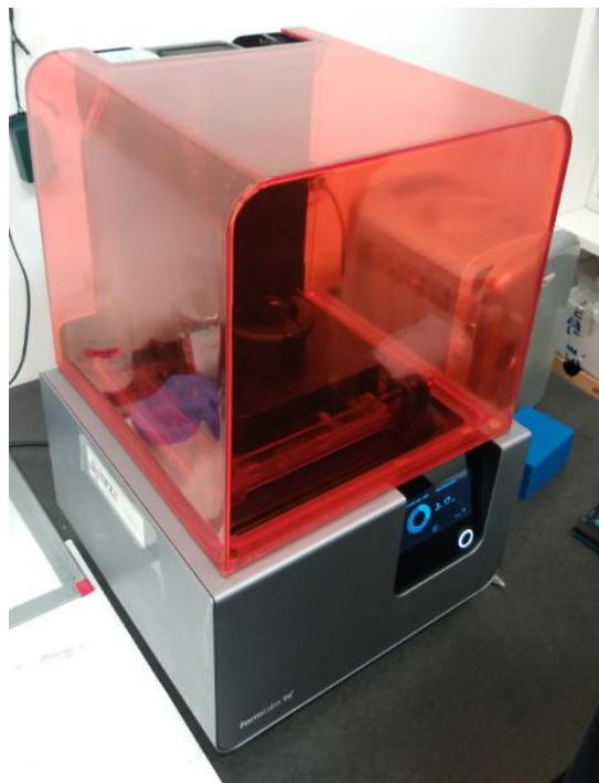
Slika 11. 3D-pisač Form 2 proizvođača Formlabs
