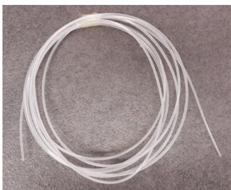
Slika 6. Komercijalni polimerni materijal (Z-ABS) u obliku filamenta
