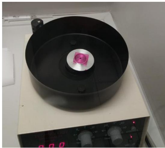
Slika 14. Pločica s nanosenim filmom nakon rotacije
