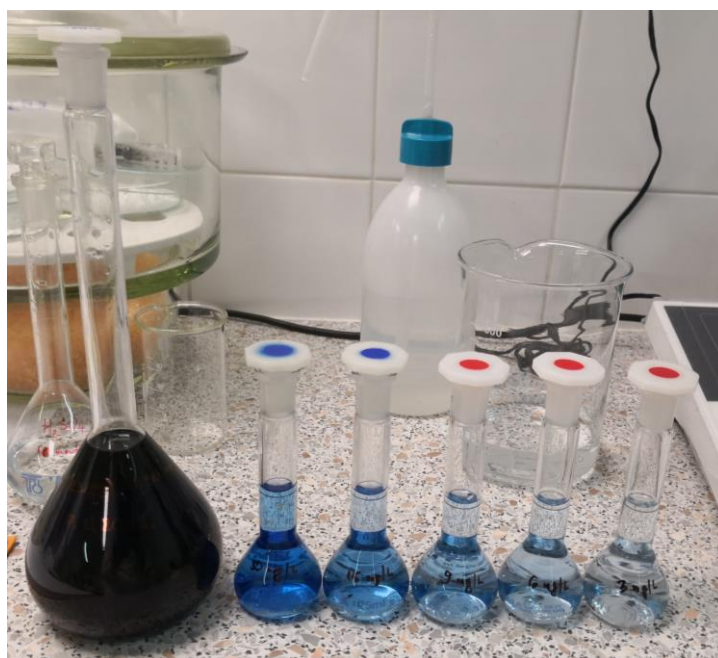
Slika 3.28. Otopine za izradu baždarnog dijagrama s koncentriranom otopinom bojila
