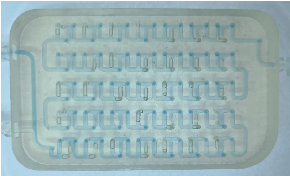
Slika 4.34. Milireaktor Mobius pri protoku od 1823 \mu\text{L}/\text{min}
