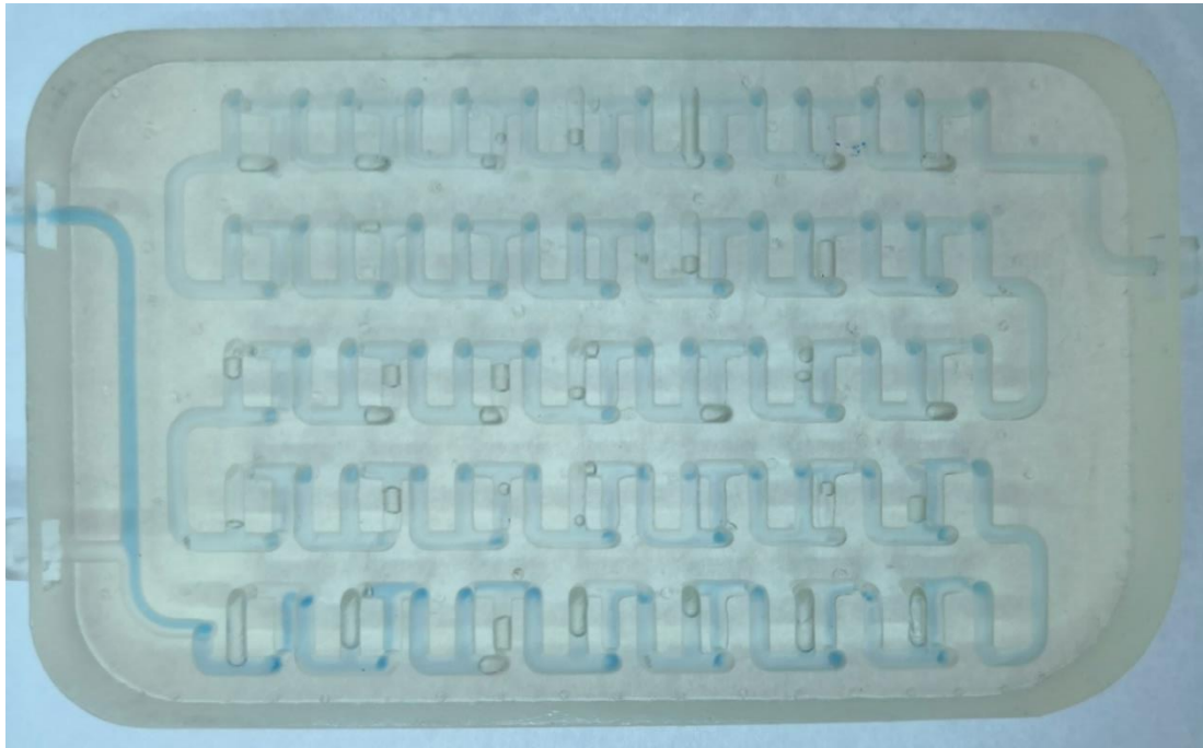
Slika 4.20. Milireaktor Mobius pri protoku od 100 \mu\text{L}/\text{min}
