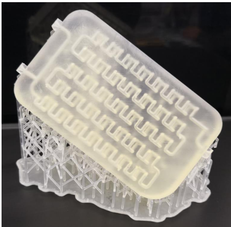
Slika 3.23. Milireaktor Mobius nakon izrade na Form 2 pisaču
