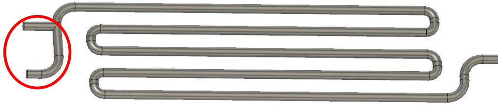
Slika 3.31. Volumen milireaktora u kojem se ne odvija reakcija prikazan je crvenom bojom
