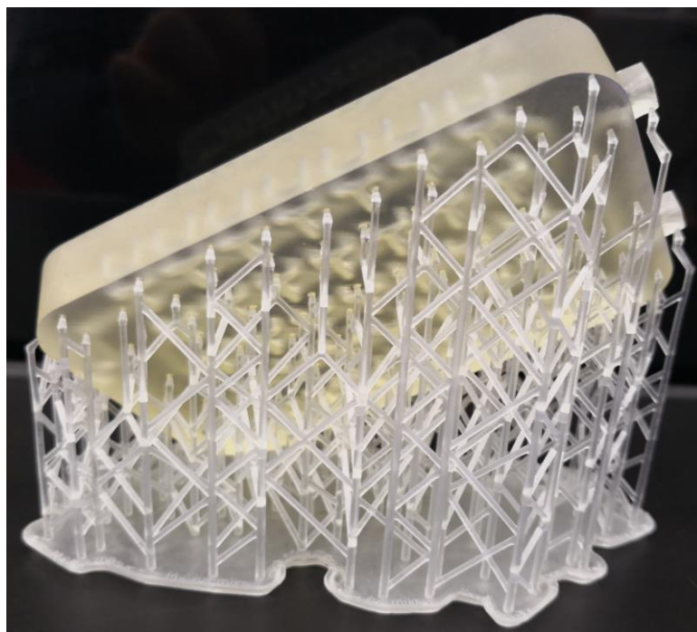
Slika 3.24. Potporne strukture milireaktora Mobius
