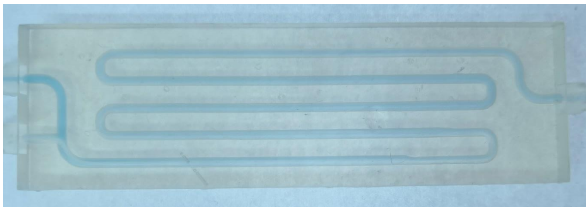
Slika 4.9. Cijevni milireaktor pri protoku od 4000 \mu\text{L}/\text{min}
