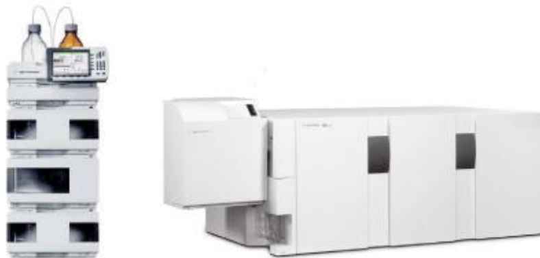
Slika 8. Agilent 1200 HPLC kromatograf vezan s trostrukim kvadrupolnim spektrometrom masa 6410
