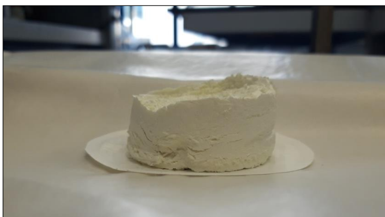
Slika52. Filtarski kolač dobiven provedbom tlačne filtracije
