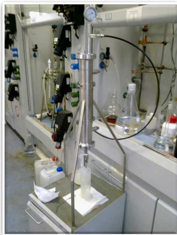
Slika 16. Tlačna filtracijska cijev za provedbu filtracije
