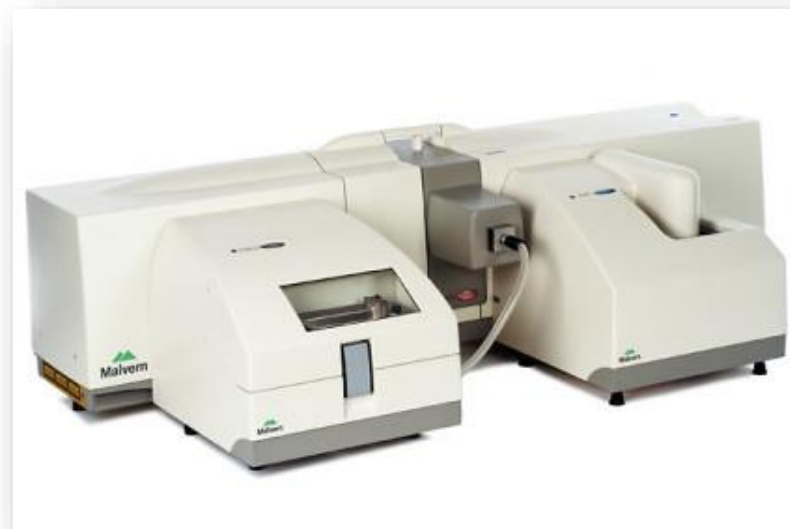
Slika 21. Uređaj za određivanje raspodjele veličina čestica Malvern
