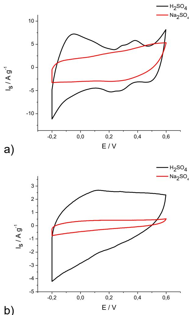
Slika 4.6 Ciklički voltamogrami elektroda a) rGO-PoPDA-0 i b) rGO-PoPDA-7 snimljeni u području potencijala od -0,2 V do 0,6 V korištenjem različitih elektrolita,  $\text{H}_2\text{SO}_4$  i  $\text{Na}_2\text{SO}_4$ .
