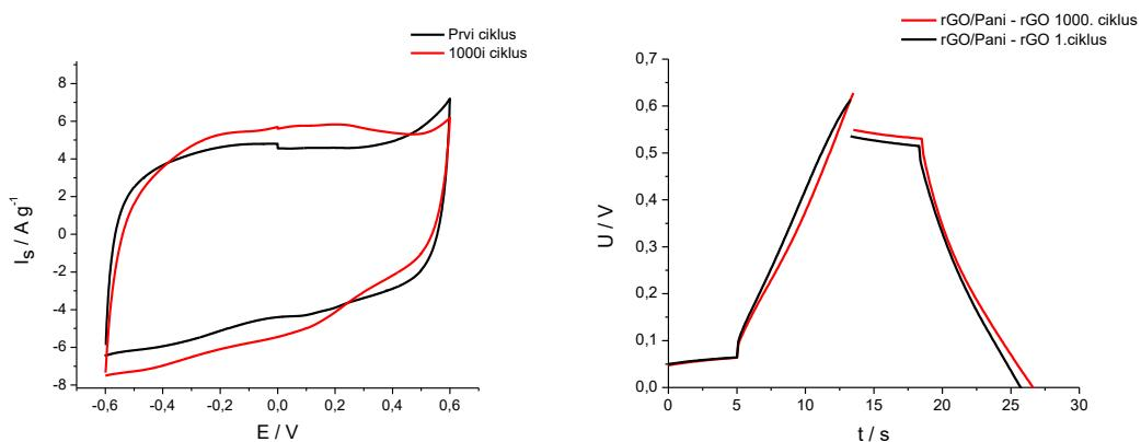
*Slika 4.10* Ciklički voltamogram za *Superkondezator2* izmјeren prije i nakon 1000 uzastopnih ciklusa punjenja i pražnjenja, brzina promjene potencijala iznosi  $50 \text{ mV s}^{-1}$ . i krivulja punjenja/praznjnenja tijekom 1000 ciklusa uz  $I_s = 4,9 \text{ A g}^{-1}$
