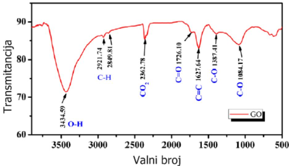
*Slika 2.18* Infracrveni (IR) spektar GO s karakterističnim vrpcama za funkcijске skupine u točno unaprijed definiranim područjima valnih brojeva, prilikom čega je na apscisi uvijek valni broj ( $\text{cm}^{-1}$ ), a na ordinati transmitancija (%).
