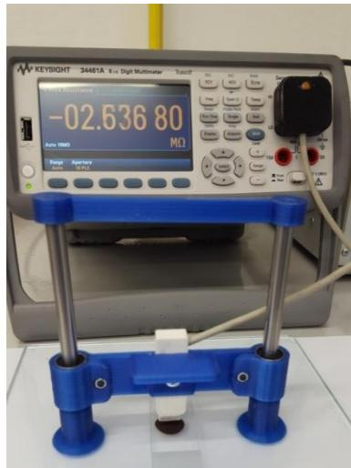
Slika 3.7 Uređaj i sonda za mjerjenje električnog otpora.
