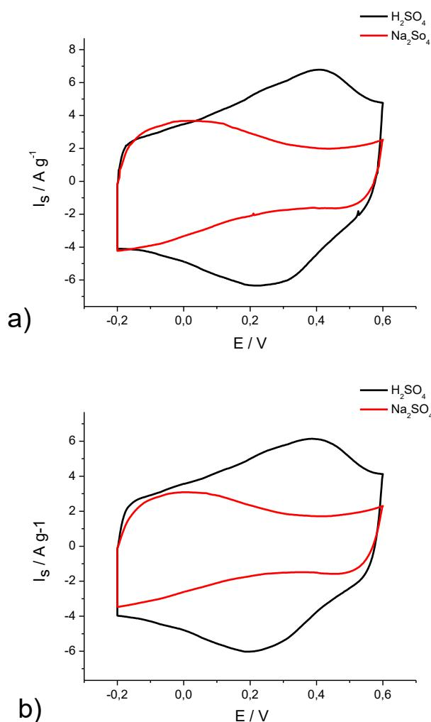
*Slika 4.2* Ciklički voltamogrami elektroda a) rGO-0 i b) rGO-7 snimljeni u području potencijala od  $-0,2 \text{ V}$  do  $0,6 \text{ V}$ , u elektrolitu  $\text{H}_2\text{SO}_4$ .
