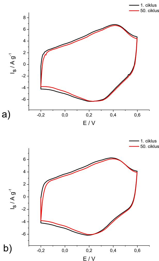
Slika 4.1 Ciklički voltamogrami elektroda a) rGO-0 i b) rGO-7 snimljeni u području potencijala od -0,2 V do 0,6 V, u elektrolitu H<sub>2</sub>SO<sub>4</sub>.
