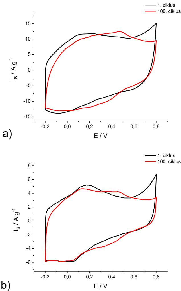
Slika 4.3 Ciklički voltamogrami elektroda a) rGO-PANI-0 i b) rGO-PANI-7 snimljeni u području potencijala od -0,2 V do 0,8 V, u elektrolitu  $\text{H}_2\text{SO}_4$ .
