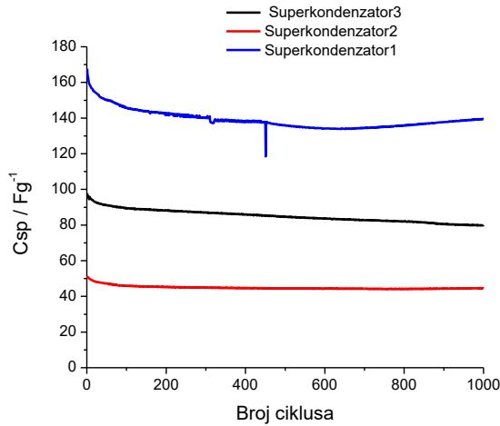
*Slika 4.12* Specifični kapacitet ( $C_{sp}$ ) superkondenzatora zabilježeni tijekom 1000 ciklusa punjenja/praznjnenja.
