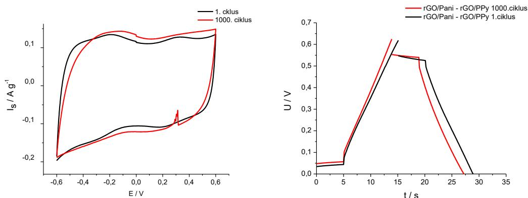
Slika 4.11 Ciklički voltamogram za *Superkondenzator3* izmjerен prije i nakon 1000 uzastopnih ciklusa punjenja i pražnjena. Brzina promjene potencijala iznosi  $50 \text{ mV s}^{-1}$ . i krivulja punjenja/praznjenja tijekom 1000 ciklusa uz  $I_s = 11,63 \text{ A g}^{-1}$ .
