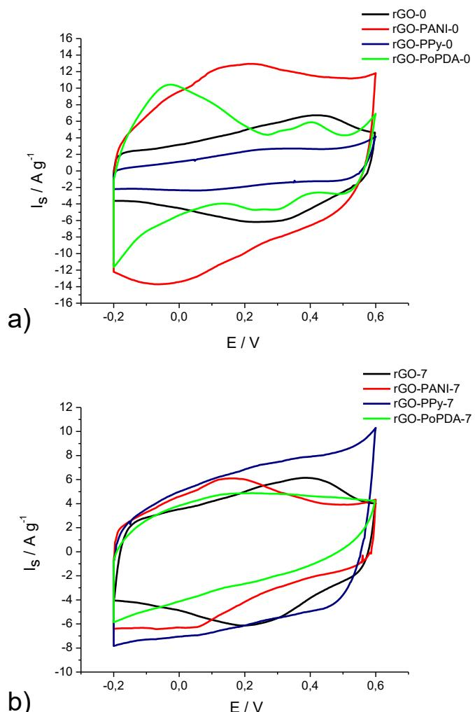
Slika 5.3 Zajednički ciklički voltamogrami rGO i pripadajućih kompozita a) pri pH=0 i b) pri pH=7 u području potencijala od -0,2 V do 0,6 V. Brzina promjene potencijala:  $v = 50 \text{ mV s}^{-1}$ .
