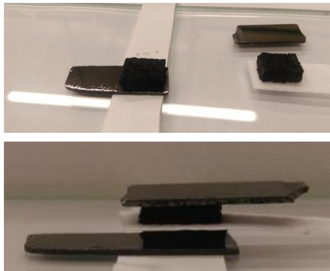
Slika 3.3 Sastavljanje superkondenzatora.
