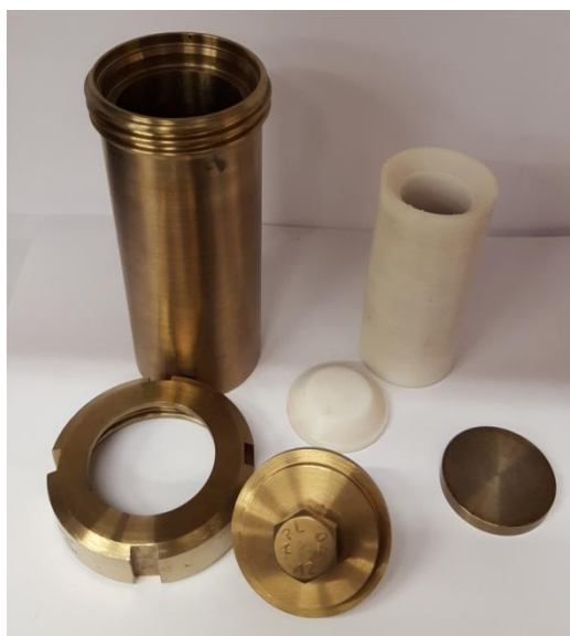
Slika 3.1 Sastavni dijelovi autoklava korištenog u procesu hidrotermalne sinteze.
