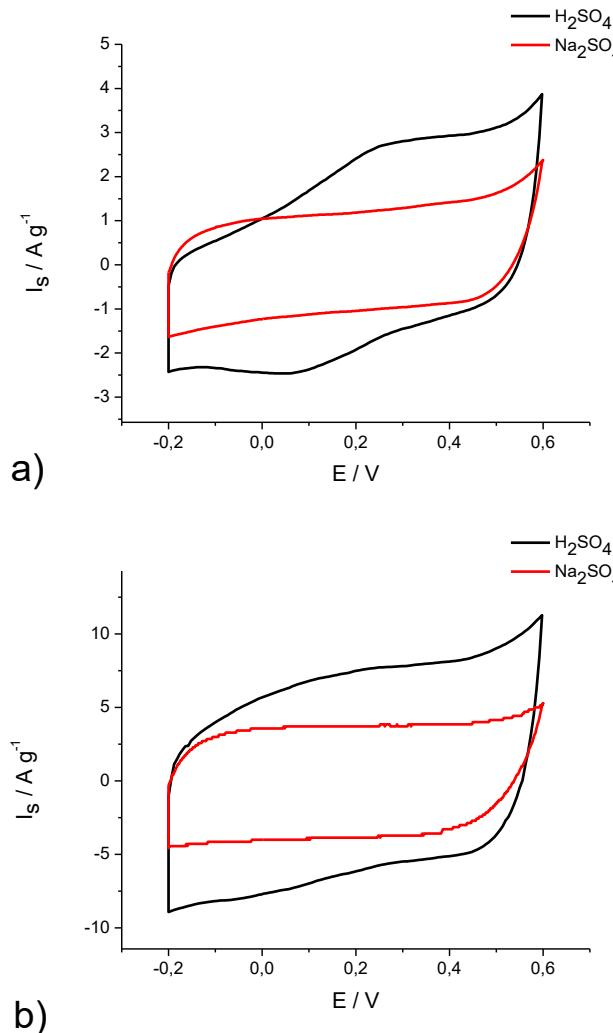
Slika 4.8 Ciklički voltamogrami elektroda rGO-PPy-0 i rGO-PPy-7 snimljeni u području potencijala od -0,2 V do 0,6 V korištenjem različitih elektrolita,  $\text{H}_2\text{SO}_4$  i  $\text{Na}_2\text{SO}_4$ .
