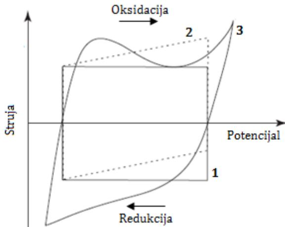
Slika 2.17 Primjeri cikličkih voltamograma za različite tipove kondenzatora: 1 – idealni kondenzator, 2 – kondenzator s unutarnjim otporom i 3 – pseudokapacitivni superkondenzator.
