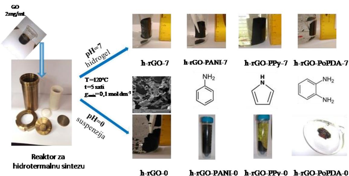
Slika 3.2 Shema hidrotermalne sinteze i dobiveni hidrogelovi.
