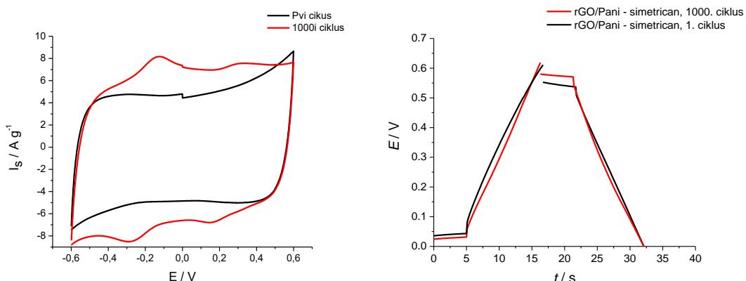
Slika 4.9 Ciklički voltamogram za *Superkondenzator1* izmјeren prije i nakon 1000 uzastopnih ciklusa punjenja i pražnjena, brzina promjene potencijala iznosi  $50 \text{ mV s}^{-1}$  i krivulja punjenja/praznjnenja tijekom 1000 ciklusa uz  $I_S = 5 \text{ A g}^{-1}$
