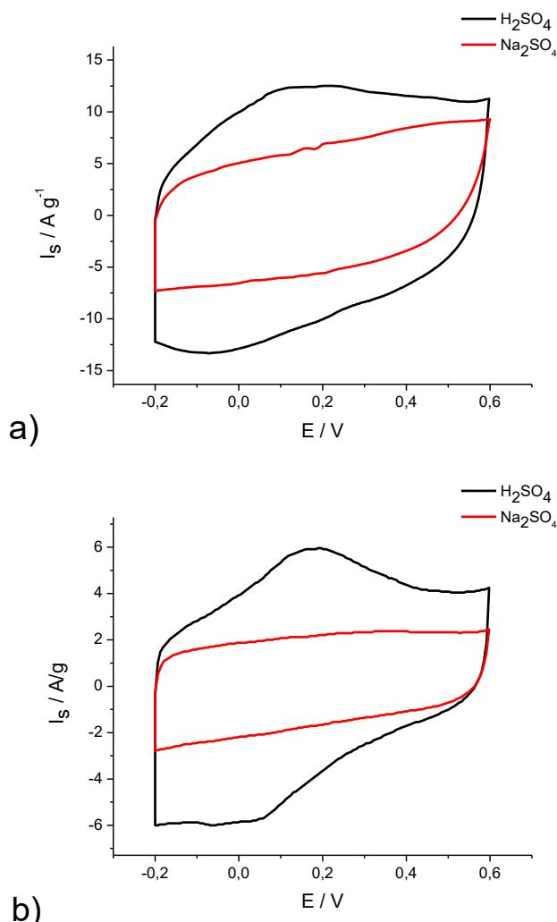
Slika 4.4 Ciklički voltamogrami elektroda a) rGO-PANI-0 i b) rGO-PANI-7 snimljeni u području potencijala od -0,2 V do 0,6 V korištenjem različitih elektrolita,  $\text{H}_2\text{SO}_4$  i  $\text{Na}_2\text{SO}_4$ .
