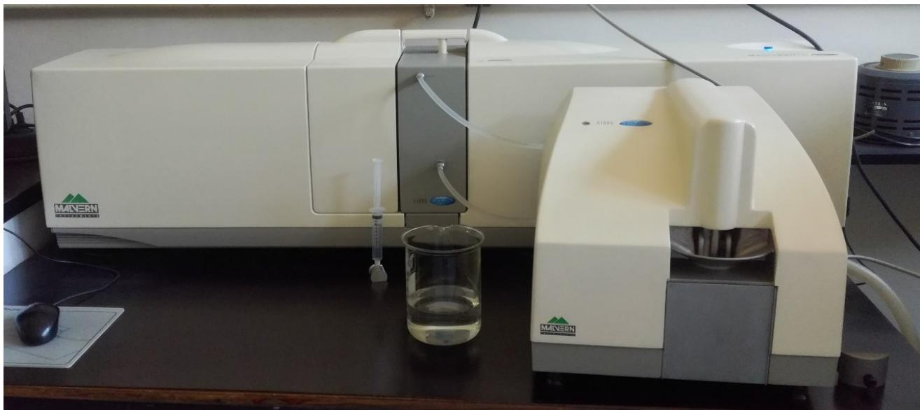
Slika 20. Malvern Mastersizer 2000 instrument za mjerenje veličine čestica.
