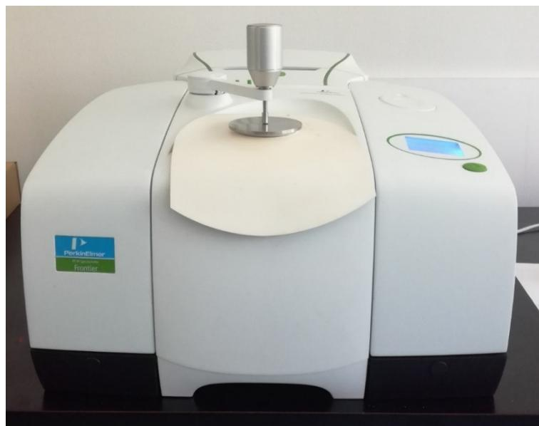
Slika 18. FTIR-ATR PerkinElmer instrument s dijamantnim kristalom.
