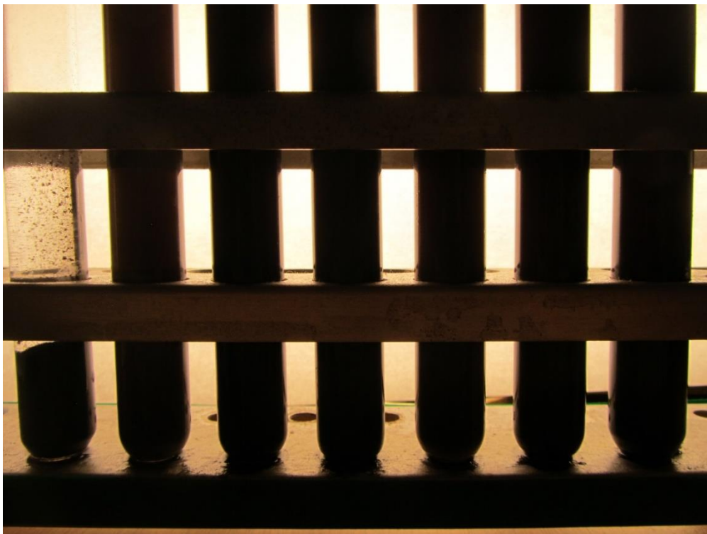
Slika 3.2.5. Fotografija nanofluida, 14. dan (s lijeva na desno PAO4 bez aditiva, K8-01, K8-05, K8-1, K10-01, K10-05, K10-1)
