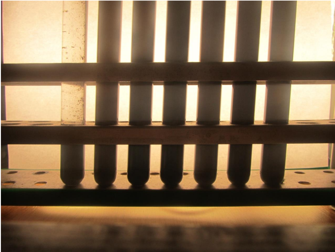
Slika 3.2.4. Fotografija nanofluida, 7. dan (s lijeva na desno PAO4 bez aditiva, K8-01, K8-05, K8-1, K10-01, K10-05, K10-1)
