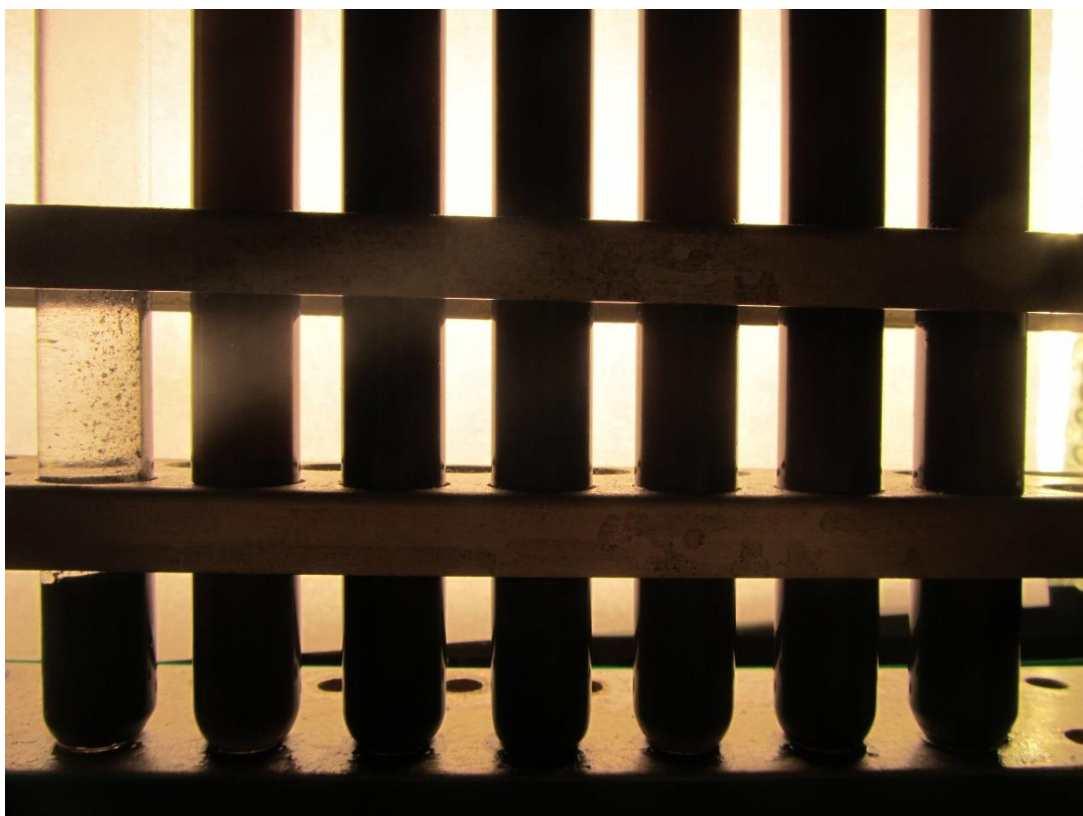
Slika 3.2.6. Fotografija nanofluida, 28. dan (s lijeva na desno PAO4 bez aditiva, K8-01, K8-05, K8-1, K10-01, K10-05, K10-1)
